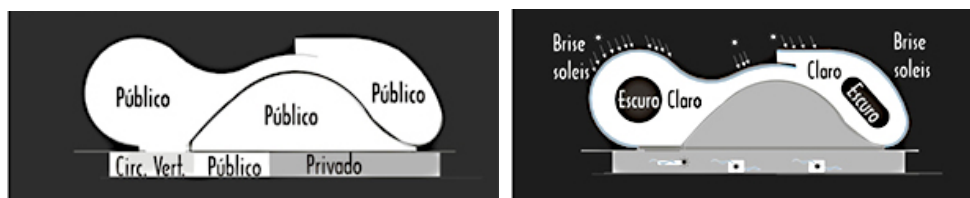
Esquemas auxiliares explicando a distribuição funcional da planta e iluminação ( fig.301)
