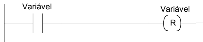
Figura 6.8 - Diagrama escada para a estrutura de reset .
