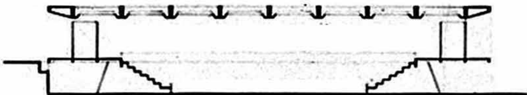
Fig. 102. Instituto Concórdia - Ginásio Corte Longitudinal
