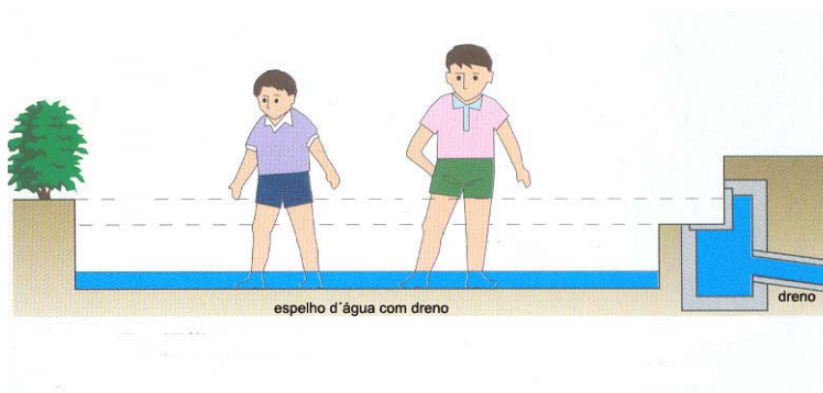
Figura 26 : Empreendimentos residenciais no Japão com sistemas de drenagem integrados à paisagem Dreno e espelho d'água para lazer. Fonte : Housing and Urban Development Corporation – Tokio -
