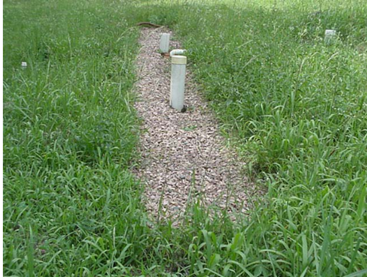
Figura 4 : Trincheira de infiltração Modelo experimental sem inspeção Local : I.P.H. Instituto de Pesquisas Hidráulicas Porto Alegre – R.S. Foto do autor / 2003
