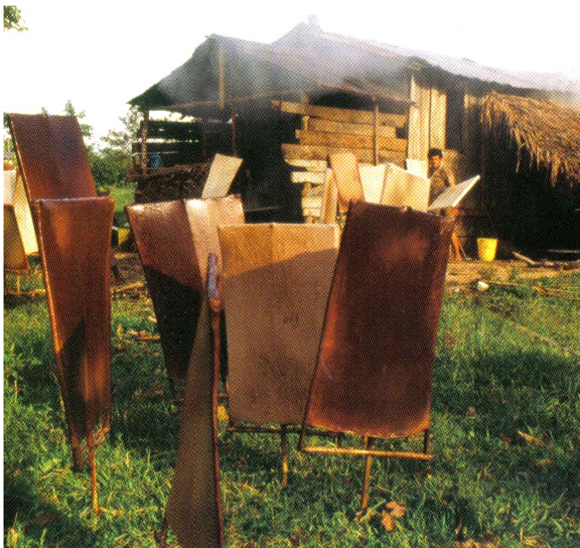
Figura 6: Fotografia de lâminas de couro vegetal secando ao ar livre após processo de vulcanização
