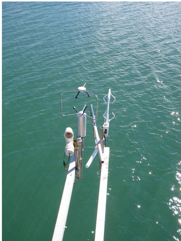
Figura 4.3: Conjuntos de medição. A esquerda o conjunto de resposta lenta; e à direita, o de resposta rápida.
