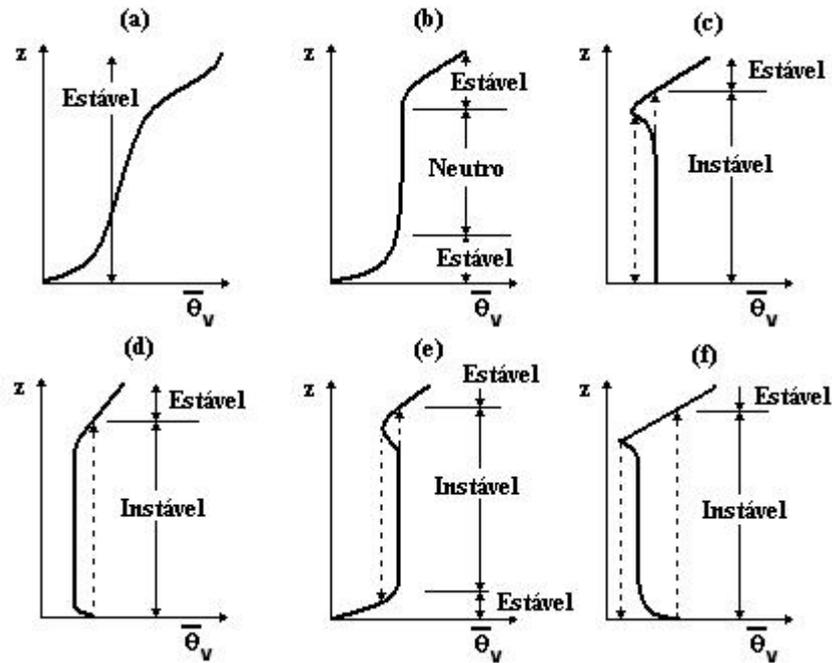
Figura 2.2: Classificação da estabilidade atmosférica segundo o perfil de temperatura potencial virtual. Figura adaptada de Arya (1999).
