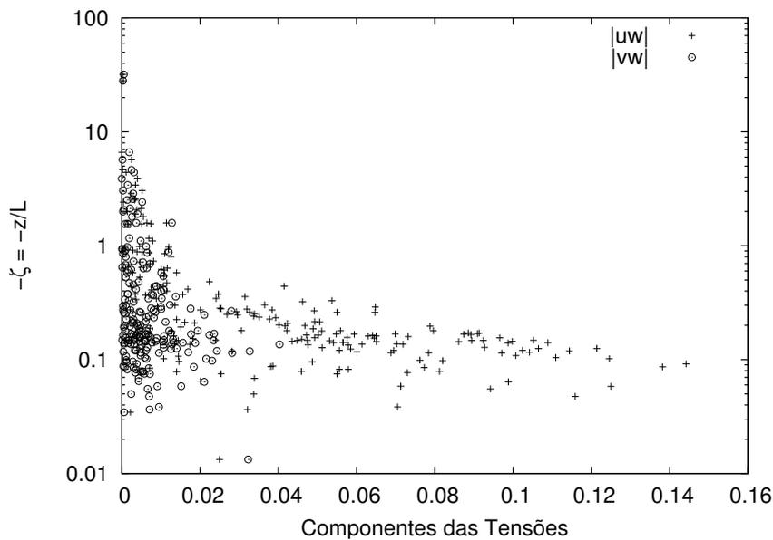
Figura 5.19: Magnitudes de  $\overline{u'w'}$  e  $\overline{v'w'}$  para os dados de Furnas. A relação de predominância da componente longitudinal sobre a transversal enfraquece com o aumento da instabilidade até o limite de convecção livre onde as duas são da mesma ordem de grandeza.
