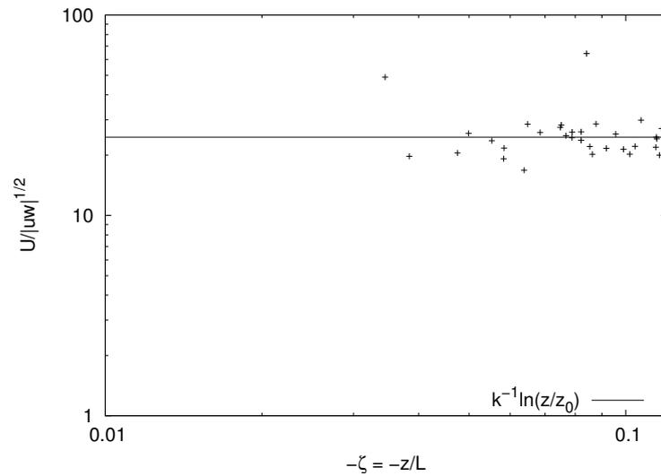
Figura 6.3: Ajuste do comprimento de rugosidade para a SDN em Furnas.
