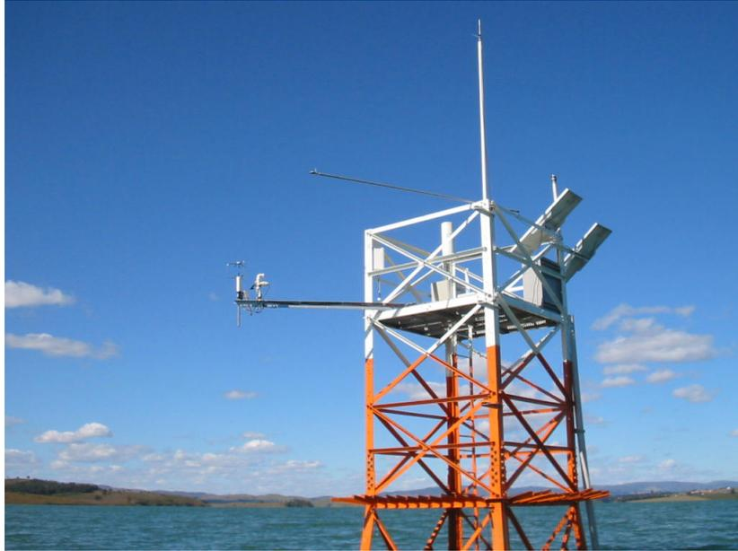
Figura 4.2: Estação Guapé: torre suporte para conjuntos de medição.
