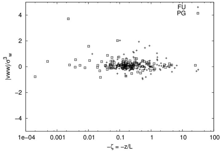
Figura 6.13: Fluxo vertical de tensões transversais cisalhantes adimensionalizada,  $\overline{v'w'^2}/\sigma_w^3$ , + - Furnas; □ - Ponta Grossa.
