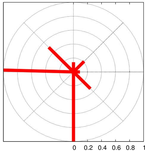
Figura 4.10: Razão entre a frequência de ventos “anômalos” com relação ao alinhamento de  $\tau$  com  $\bar{U}$  pelo total da frequência de ventos apurados para cada setor de  $45^\circ$ , para o CSAT3, mostrando como a torre afeta estas medidas.
