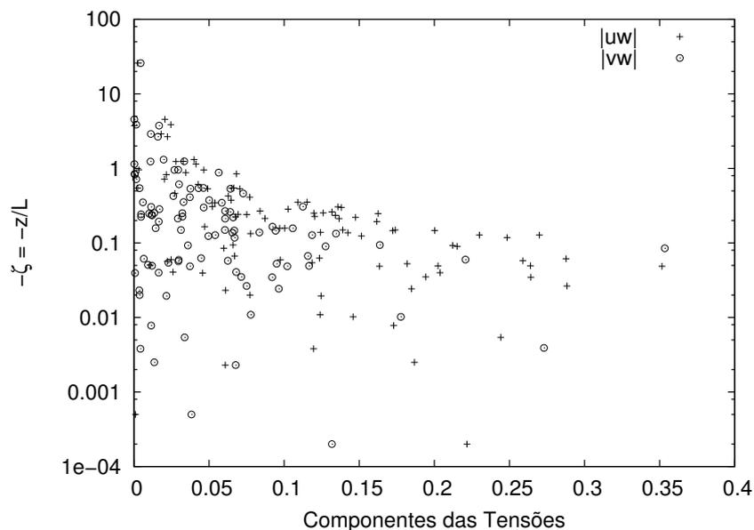
Figura 5.21: Magnitudes de  $\overline{u'w'}$  e  $\overline{v'w'}$  para todos as séries temporais de Ponta Grossa, mostrado para incluir dados que se aproximem do limite de convecção livre.
