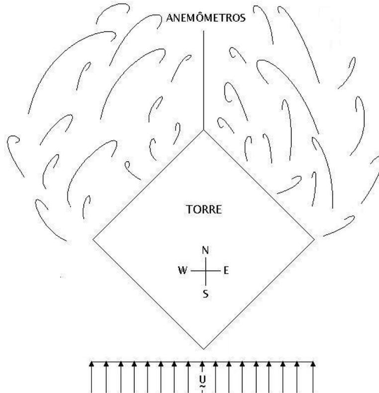
Figura 4.9: Esteira de vento formada pelo escoamento vindo ao sul da torre, atingindo os anemômetros e corrompendo o escoamento pela presença do obstáculo.
