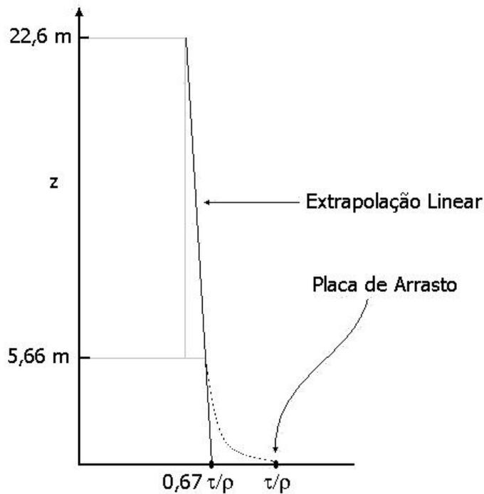
Figura 3.2: Idealizações das medidas de  $u_* = \tau_0/\rho$  realizadas por Haugen et al. (1971). A diferença entre as medidas dos anemômetros situados 22,6 e 5,66 m é extrapolada até a superfície e a fração desta extrapolação em relação aos valores medidos nas placas de arrasto, 0,67 na média, é usado como fator de correção.
