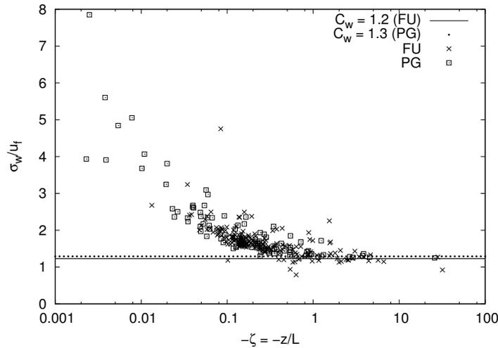
Figura 5.23: Desvio padrão de  $w$  adimensionalizado por  $u_f$ . A linha cheia representa o ajuste para os dados de Furnas, enquanto que a linha pontilhada representa o ajuste para os dados de Ponta Grossa.
