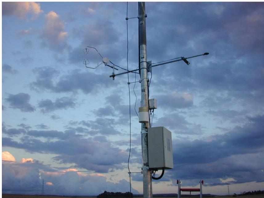
Figura 4.7: Anemômetro sônico *Campbell CSAT3* operando acoplado à torre da figura 4.6.
