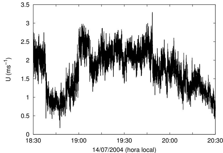
Figura 2.3: Exemplo de um sinal turbulento típico na CLA. Velocidade longitudinal instantânea medida a 20 Hz. Data: 14/07/2004, hora local: 18:30 às 20:30.
