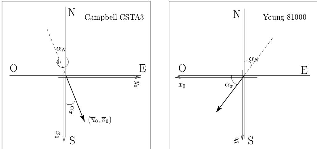
Figura 4.5: Esquema de alinhamento dos Anemômetros Sônicos.
