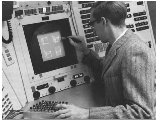
Fig.64: Imagem de usuário em dispositivo de caneta ótica. Importante notar o equipamento e botões necessários para equipamentos à época. Data provável: início da década de 1960. http://w3.impa.br/~pcezar
