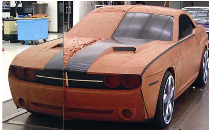
Fig.90: Modelo bipartido em clay em processo. O uso do espelho permite visão da simetria. Dodge Challenger. In: www.cardesignews.com . Aprox. 2004.
