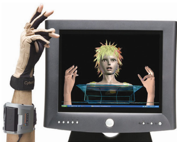
Fig. 59: Luvas para inserção de mão virtual com possibilidade de interação e manuseio de objetos em ambiente computacional.
