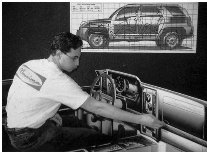
Fig.91: Modelo 2D para estudo ergonômico em processo. In: Carstyling, nº149 de julho de 2002.
