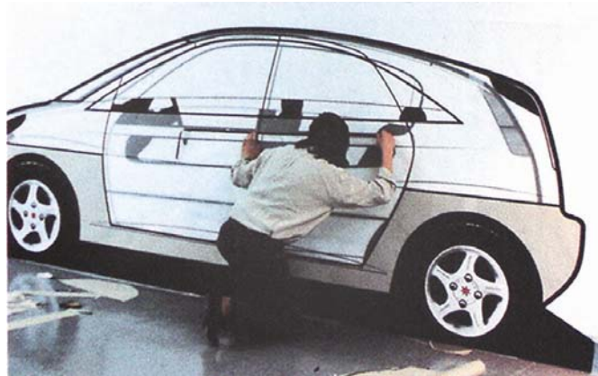
Fig. 79: Package leiaute ou tape drawing do estúdio de design australiano Millard. In: CarStyling nº 126, de setembro de 1998.
