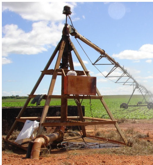
Figura 2.10. – Ponto e painel central de um pivô central de irrigação (fonte: Autor)
