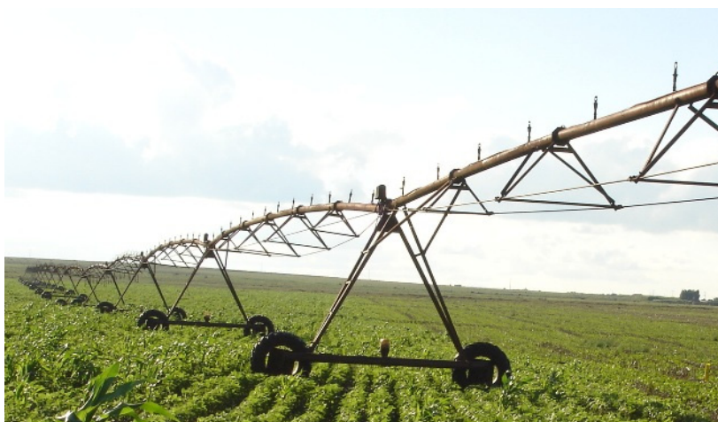
Figura 2.9. – Sistema de irrigação por aspersão tipo pivô central (fonte: Autor)
