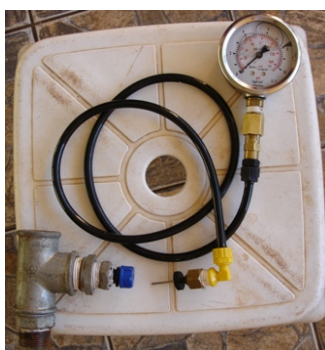
Figura 5.11. – Manômetro e acessórios para medição da pressão ao longo da linha lateral
