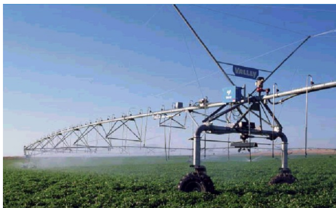
Figura 2.11. – Braço giratório de um pivô central de irrigação (fonte: VALLEY, 2003)
