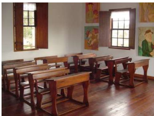
Figs. 72 e 73: Acima à esquerda, vista da sala de aula, totalmente restaurada, com seus móveis originais. O interior da escola era rebocado com argamassa de barro. O assoalho é todo em tábuas de pinheiro.
