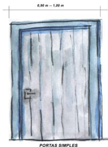
Figs. 62 e 63: acima, croqui esquemático da porta simples, com tábuas encaixadas em macho-fêmea. À direita, fotografia da porta dos fundos da Casa Seidl, com fechadura original.
