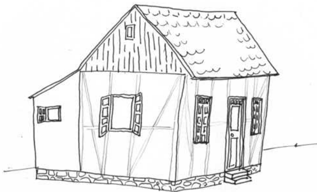
Fig. 84: Croqui esquemático da casa principal. A estrutura em enxaimel se dispõe conforme o desenho, porém não é aparente. É possível, porém, adivinhar sua estrutura devido às rachaduras no revestimento.
