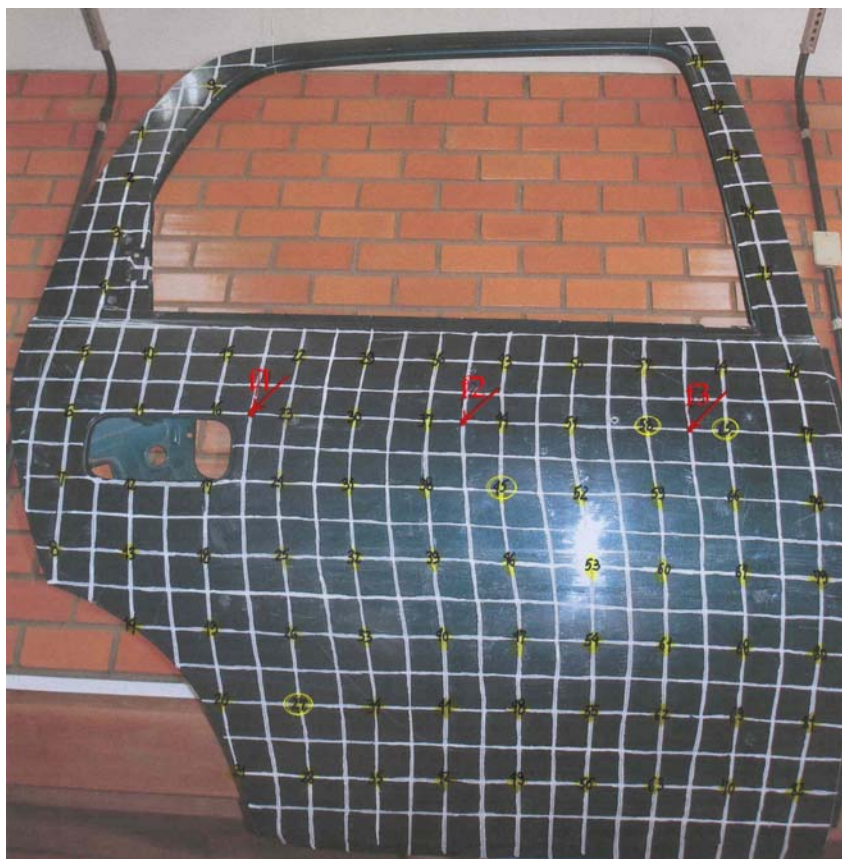
Figura 4.10 – A distribuição dos 82 nós ao longo da malha modal experimental e no detalhe, os quatro pontos ótimos (27, 45, 58 e 65) e as três forças (f1, f2 e f3)
