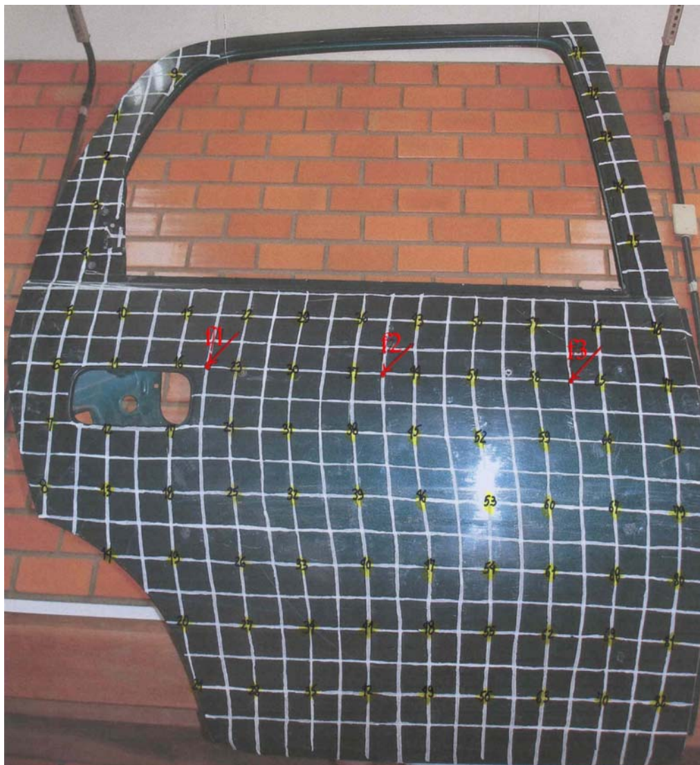
Figura 3.10 – Exemplo de malha para análise modal experimental
