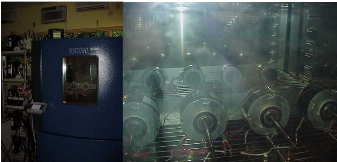
Figura 9.2. Fotos da vista externa da câmara climática e dos motores instalados no seu interior
