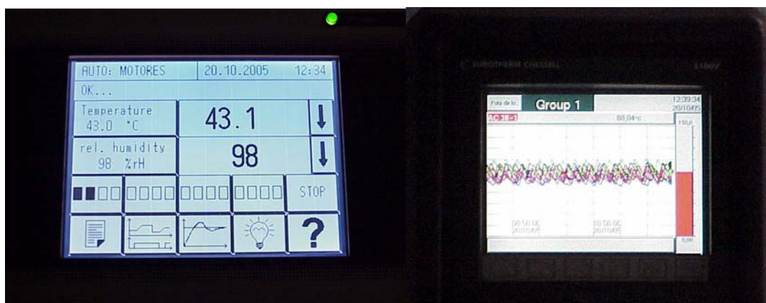
Figura 9.3. Fotos da tela de comando da câmara climática e da tela do sistema de aquisição de dados de temperatura
