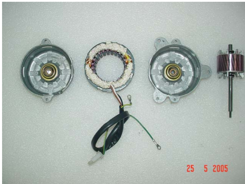
Figura 3.2 – Foto dos componentes de um motor AC33 Fonte: Cortesia WEG S.A.
