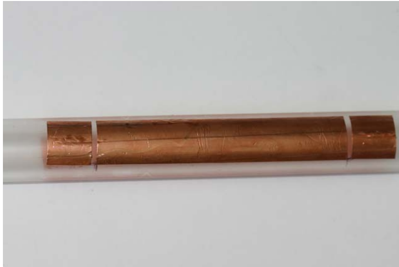
Figura II.2 – Posição dos eletrodos sobre o tubo de acrílico.
