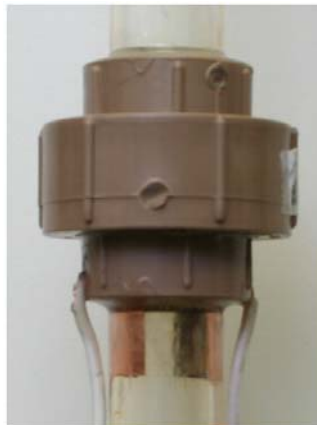
Figura 3.12 – Eletrodos de cobre instalados.
