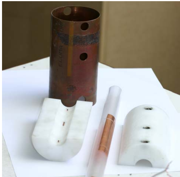
Figura II.4 – Elementos do sistema de blindagem.
