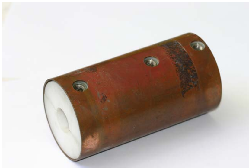
Figura II.5 – Montagem do sistema de blindagem.
