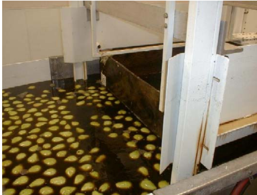
Figura 7 – Limpeza de Pêras por Imersão com Solução Aquecida (BURGUESS, 2005).
