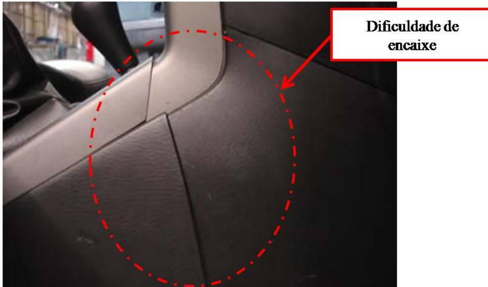
FIGURA 23 - DEFEITO DECORRENTE DE DIFICULDADE DE ENCAIXE DA COIFA DA ALAVANCA DE MUDANÇAS NO CONSOLE CENTRAL
