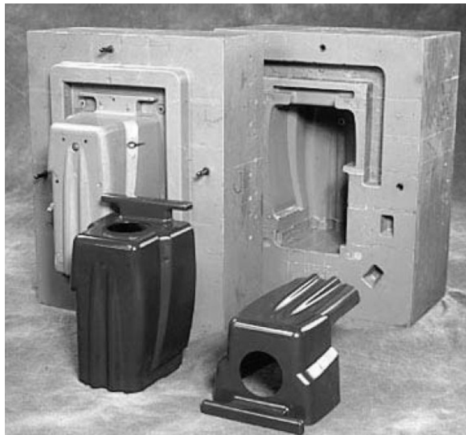
Figura 6 - Molde confeccionado em resina epóxi (VANTICO, 2001).
