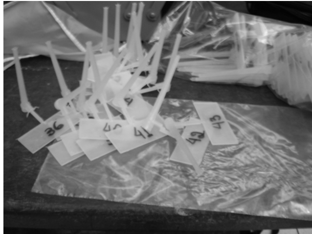
Figura 37 - Algumas peças obtidas durante os experimentos de moldagem e respectivas numerações.
