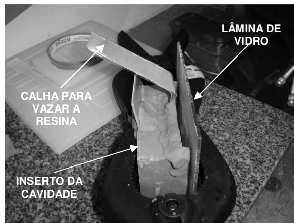
Figura 33 - Preenchimento do inserto do ponto de injeção diretamente no inserto da cavidade.
