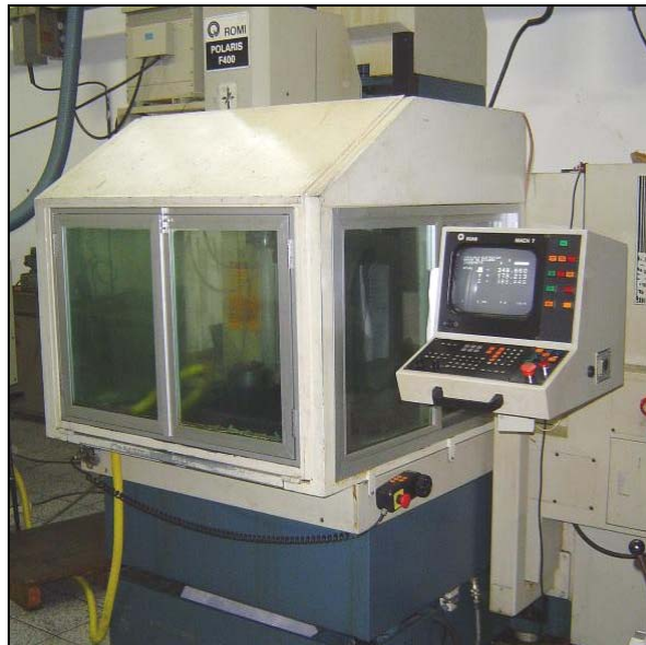
Figura 3.3 – Fresadora utilizada na realização dos ensaios de aquisição de forças
