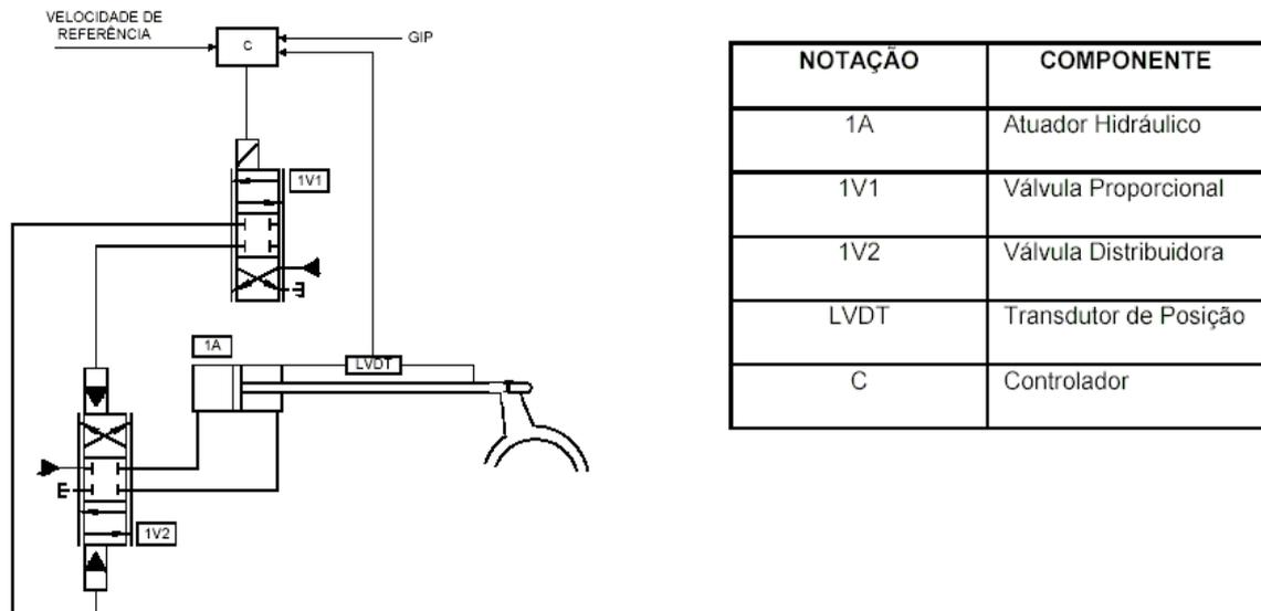
Figura 2.6 Sistema mecânico-hidráulico simplificado do regulador moderno
