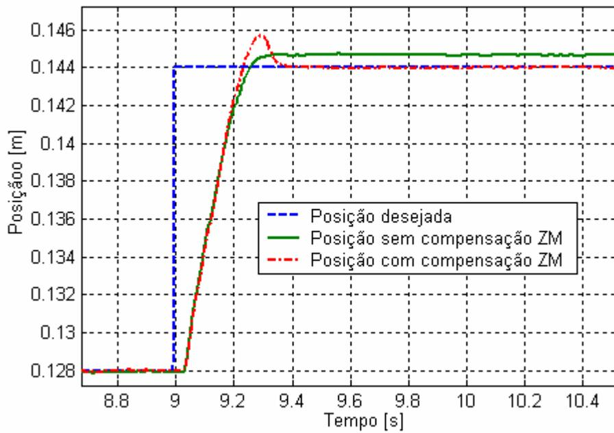
Figura 5.8 Detalhamento do degrau positivo (resultados experimentais)
