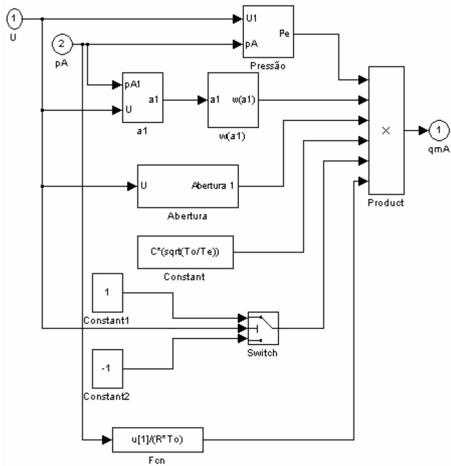
Figura D.3 Conteúdo do bloco de número [1.1], representativo da equação de vazão da válvula na via A
