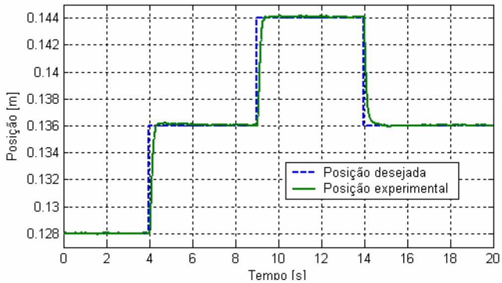
Figura 5.19 Resposta do sistema com força de carga nominal para uma seqüência de degraus de 5% do curso do cilindro, com posição inicial do êmbolo de 128mm;  $K_p=280$ ,  $K_I=0.2$ ,  $K_D=20$ ..
