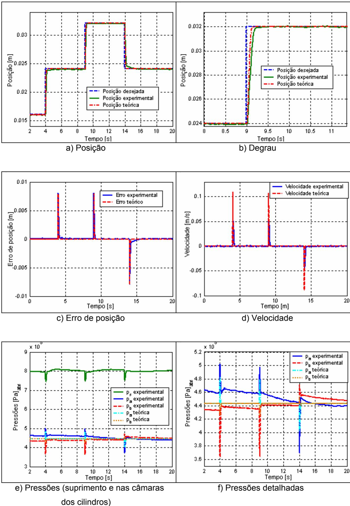
Figura 5.6 Resposta do sistema sem carregamento para uma seqüência de degraus de 5% do curso do cilindro, com posição inicial de 16mm com compensação de ZM;  $K_P=280$ ,  $K_I=0.2$ ,  $K_D=6$ .
