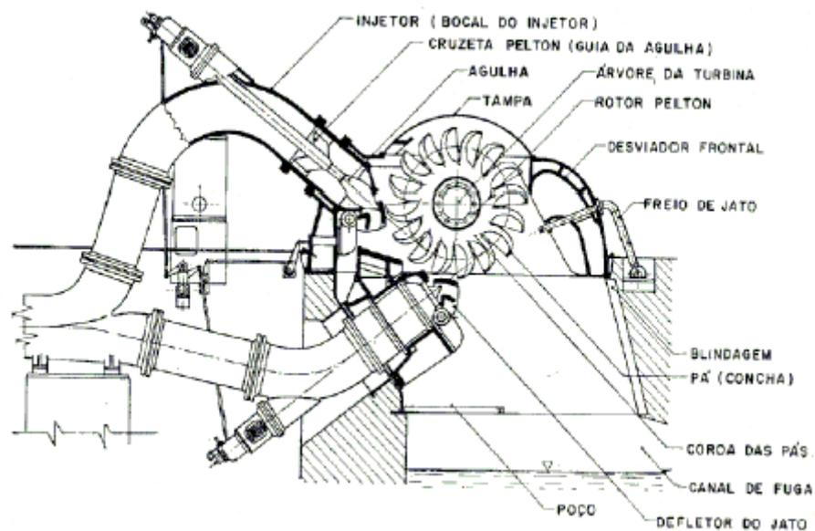
Figura 2.4 Corte Transversal de uma turbina Pelton de dois jatos (MACINTYRE, 1983)
