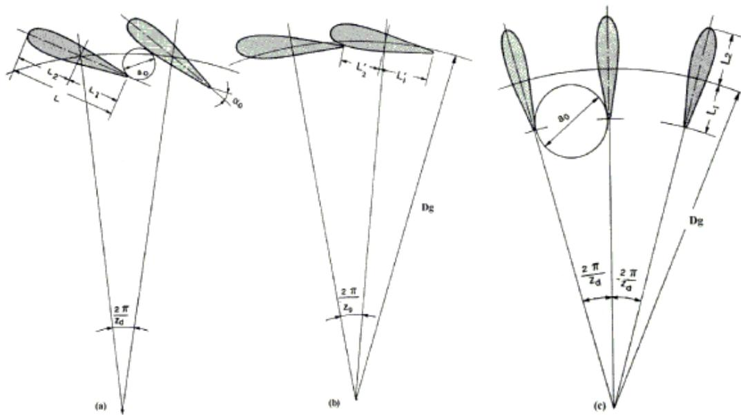
Figura 2.13 Pás do distribuidor: a) posição de abertura; b) posição de fechamento; c) posição de abertura máxima (MATAIX, 1975).
