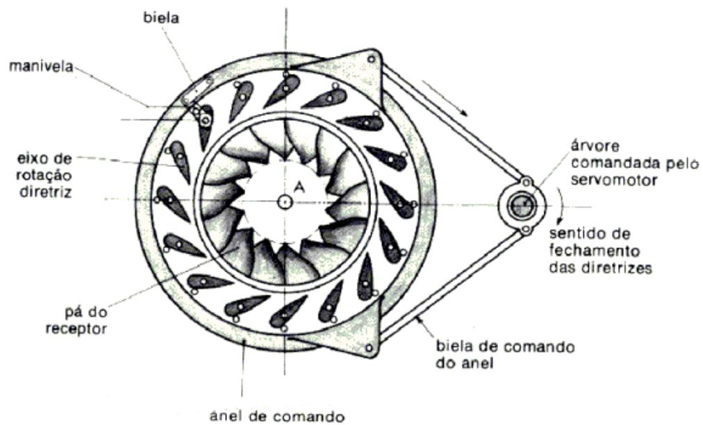
Figura 2.8 Anel de regularização de turbina Francis e comando das pás diretrizes do distribuidor (MATAIX,1975).
