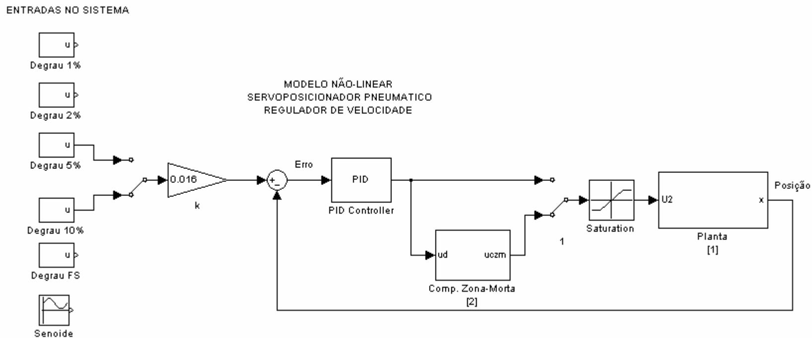
Figura D.1 Diagrama de blocos geral representativo do sistema servopneumático em malha fechada
