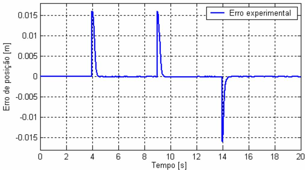
Figura 5.22 Erro de posição para uma seqüência de degraus de 10% do curso do cilindro
