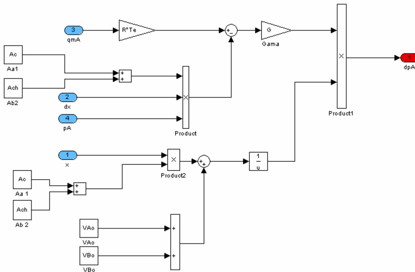
Figura D.5 Conteúdo do bloco de número [1.3], representativo da equação de continuidade dos cilindros no volume A
