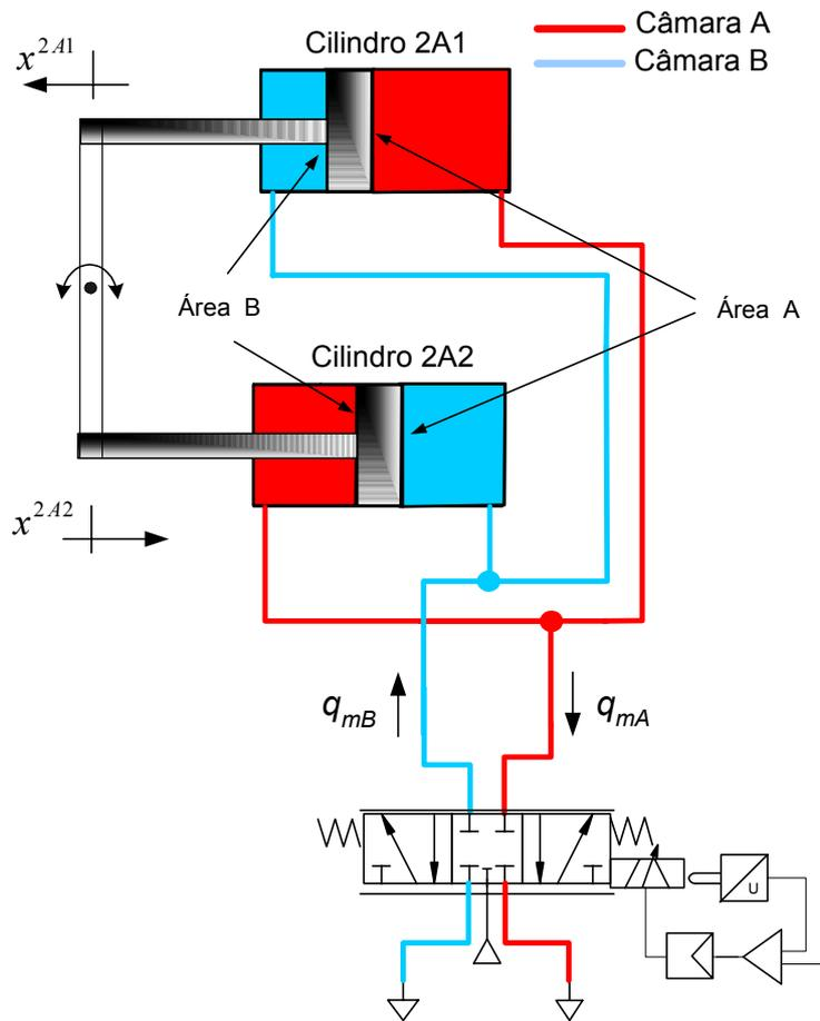
Figura 3.4 Configuração das câmaras do circuito pneumático
