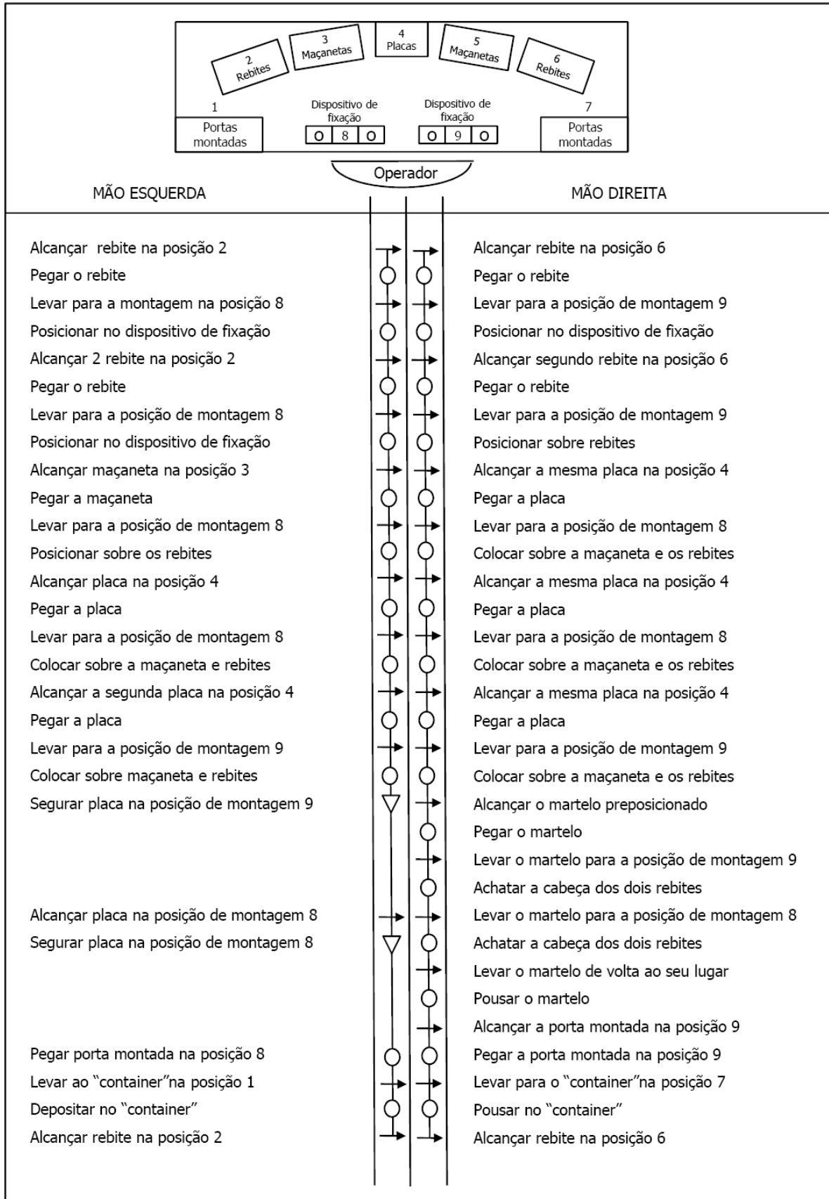
Figura 07 - Gráfico mão direita-mão esquerda para a montagem da porta de correr pelo método melhorado
