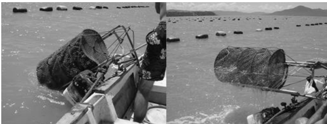
FIGURA 6.1 – Etapas do processo de lavação com protótipo: a) içamento e b) lavação.
