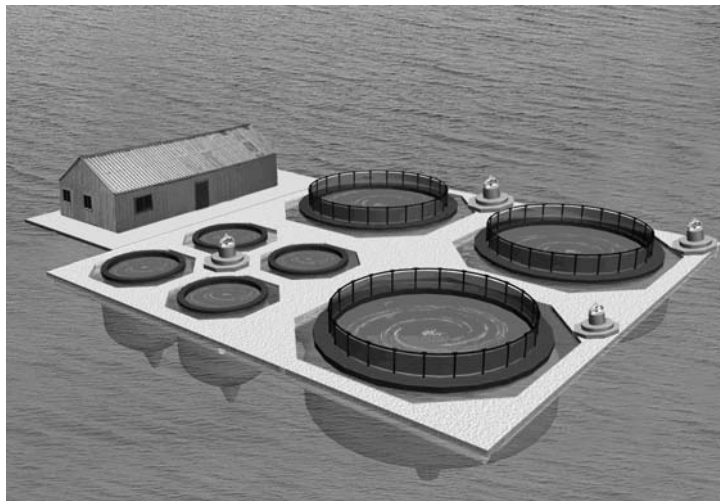
FIGURA 2.7 – Sistema flutuante para criação de peixes (fonte: Future SEA Technologies Inc.).
