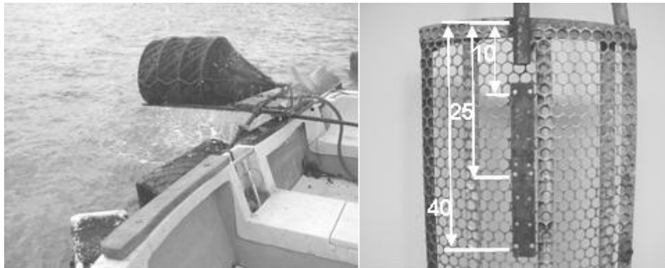
FIGURA 5.5 – Teste do ponto de articulação. a) Modelo construído b) Detalhe dos pontos testados.
