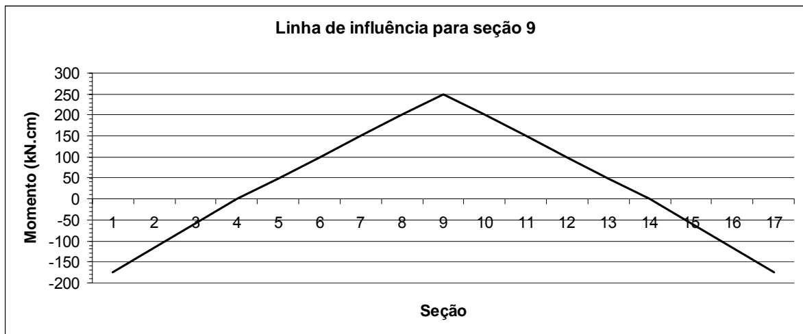
Figura 6.3.2 – Linha de influência do momento para a seção 9
