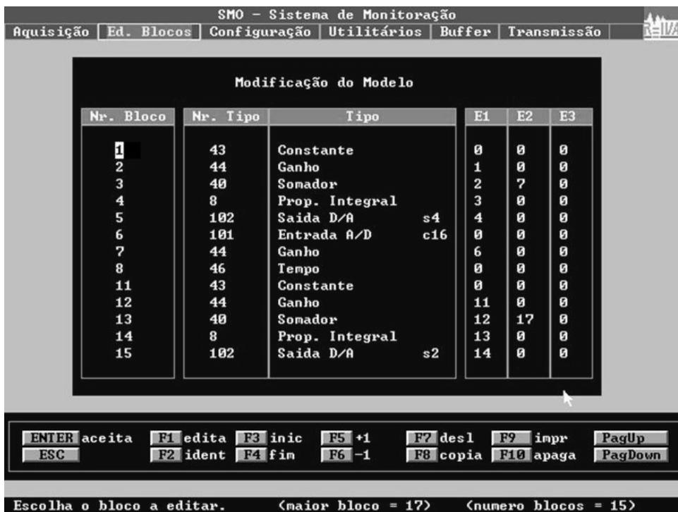
Figura 4.5 – Montagem do diagrama de blocos no *software* SMO.
