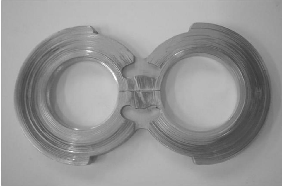
Figura 2.14 – Placa desgastada pela contaminação.
