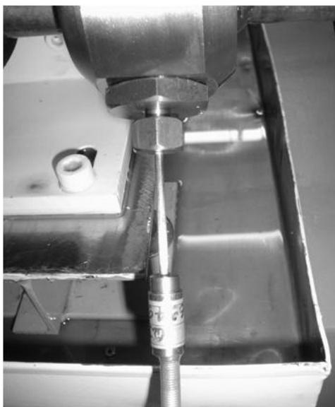
Figura A.6 – Termopar tipo “J”.
