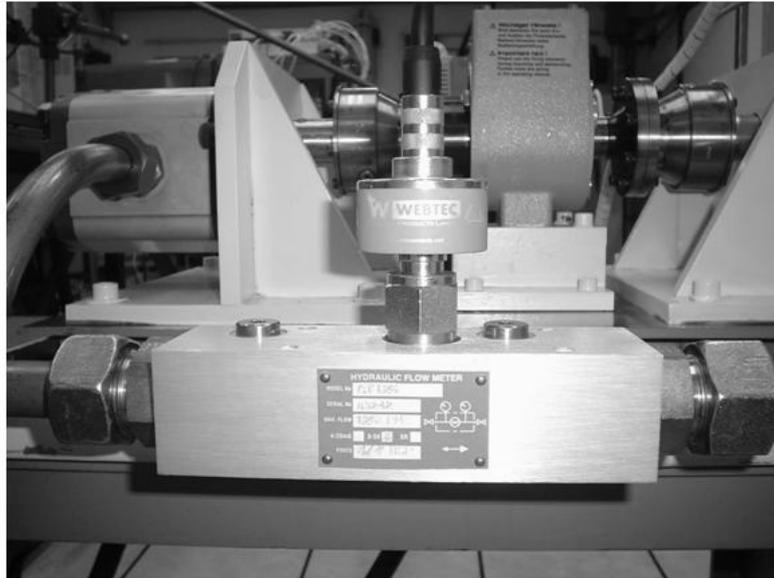
Figura A.3 – Transdutor de vazão.
