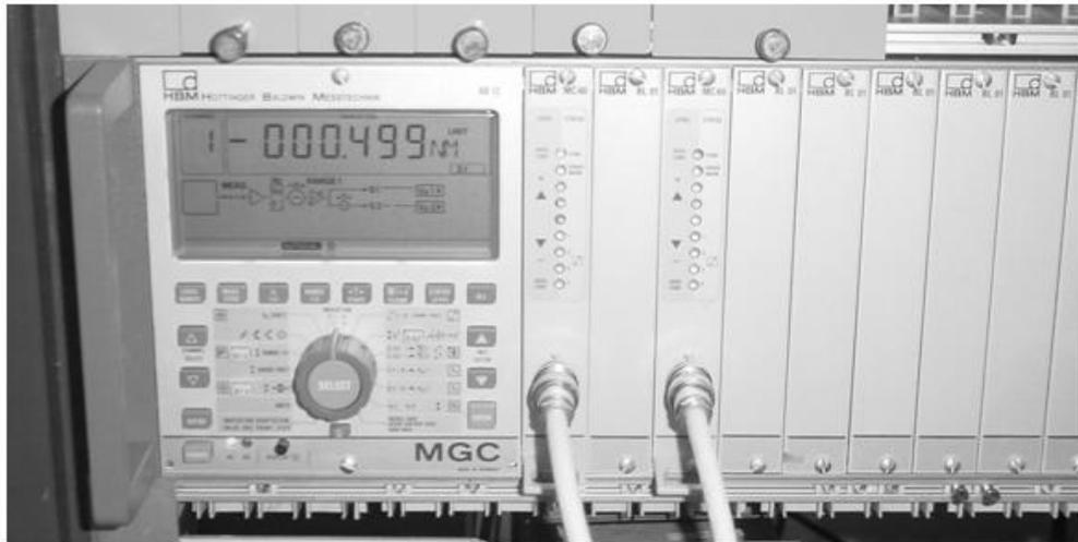
Figura A.5 – Condicionador de sinais de torque e rotação.
