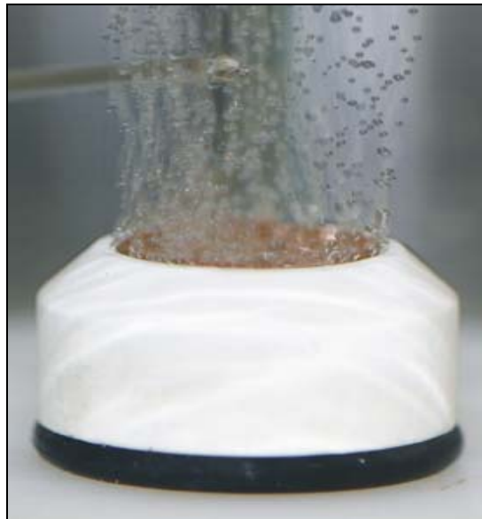
Figura 3.5 – Seção de teste com ebulição do FC-87, q = 30,01 \text{ kW/m}^2 , T_p = 42,5^\circ\text{C}
