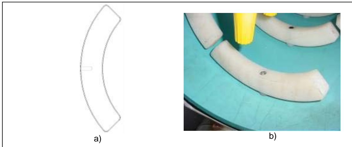
Figura 6.2 – Fixação das pás no tubo transportador.
