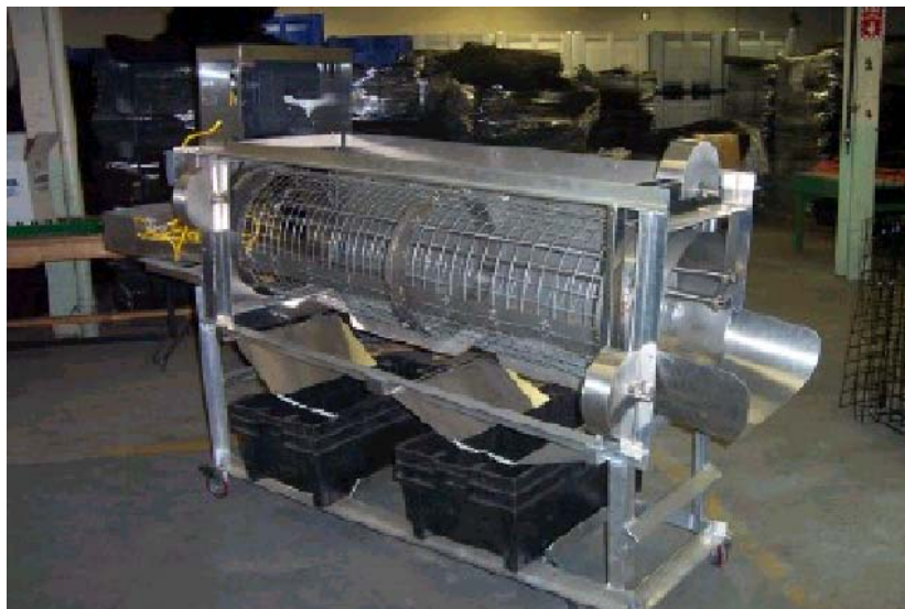
Figura 2.21 - Classificadora tubular fabricada no Canadá. Fukui Aquaculture (2003)
