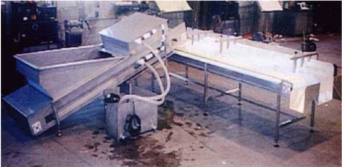
Figura 2.18 - Máquina de limpeza canadense, acoplada a um sistema de classificação do tipo passa-não-passa. Fukui Aquaculture (2003).
