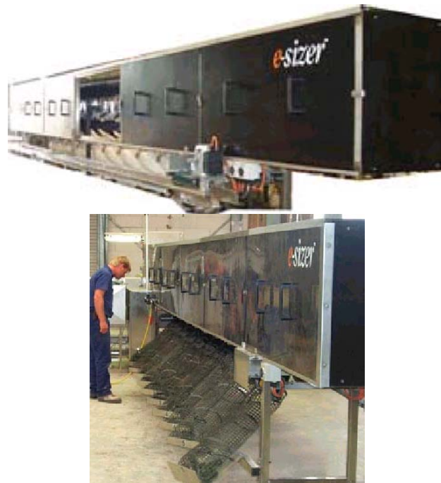
Figura 2.23 - Classificadora eletrônica de ostras. SEDESIGN (2003).
