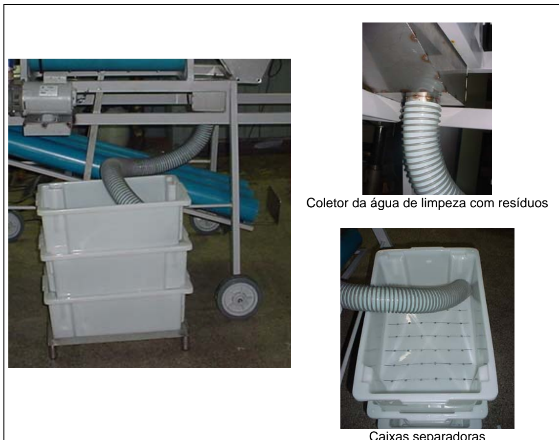
Figura 6.9 – Conjunto separador coletor de resíduos.
