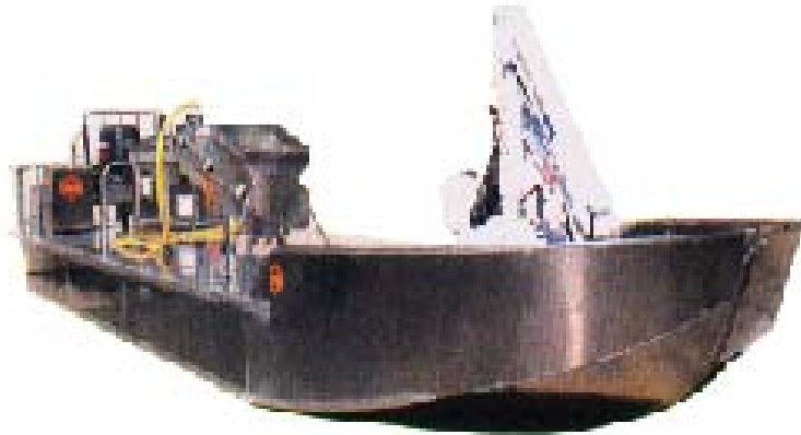
Figura 2.15 - Embarcação de trabalho dotada de sistema de elevação de carga utilizada pelos ostreicultores franceses. Mulot (2003).
