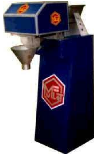
Figura 2.24 - Máquina utilizada para a pesagem e embalagem de ostras. Mulot (2003).
