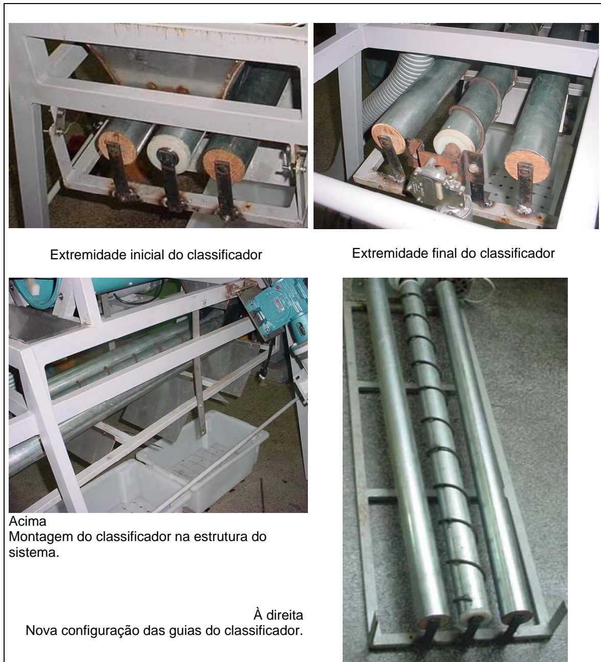
Figura 6.16 – Detalhes das mudanças efetuadas no classificador.
