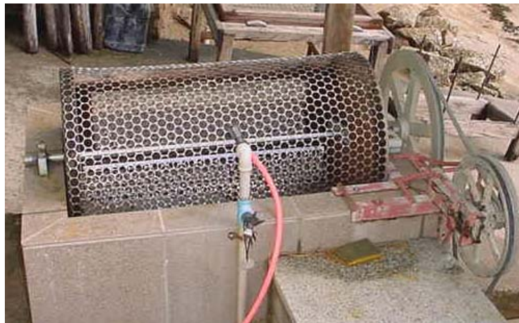
Figura 2.11 - Dispositivo de limpeza de ostras por tambonamento.
