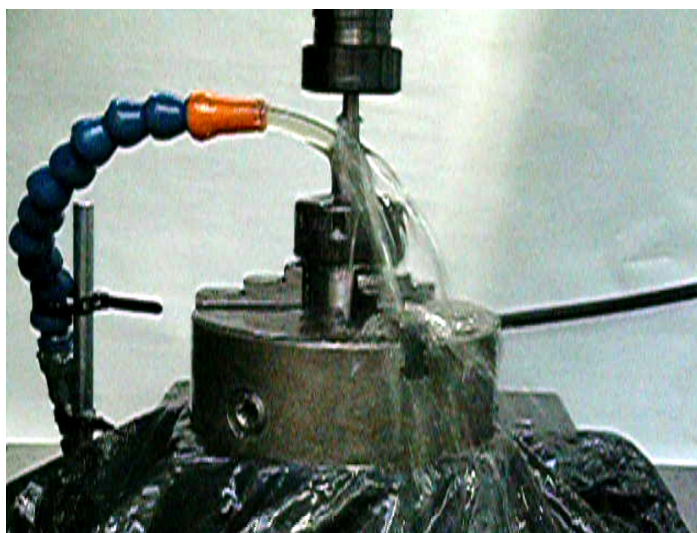
Figura 3.8 – Aplicação de fluido de corte
