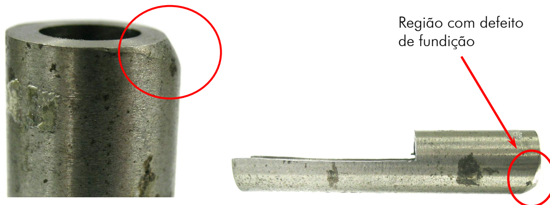
Figura A.2 – Problema de fundição resultando em problemas de desvio de furo
