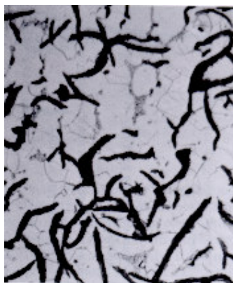
Figura 2.19 – Grafita envolta pela matriz ferrítica [35]
