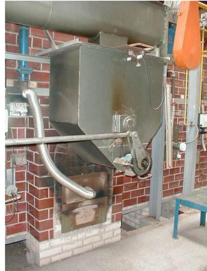
Figura 3.6: Caixa de alimentação de serragem, com acionamento por catraca; parte inferior, a grelha onde é injetado o ar de combustão.
