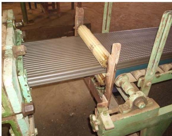
Figura 1.5: Extrusão da massa cerâmica.
