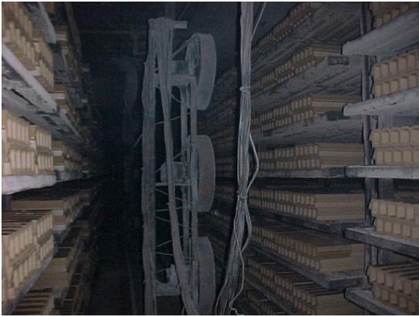
Figura 1.7: Peças úmidas no interior de um secador.
