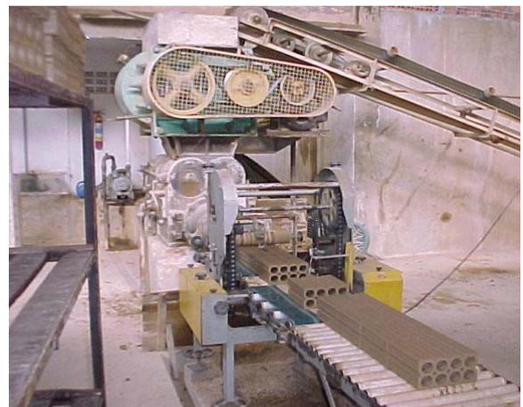
Figura 1.6: Corte para dimensionamento final da peça.
