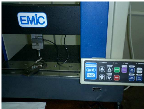
Figura 8. Máquina universal de ensaio mecânico EMIC ® , modelo DL 3000.
