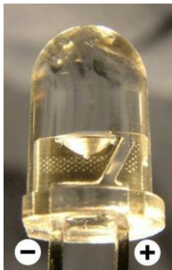
Figura 2.16 Identificação do terminal K através do tamanho.
