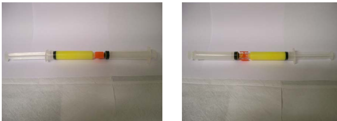
Figura 12 - Mecanismo de extrusão: o conteúdo das seringas foi homogeneizado empurrando-se lentamente um êmbolo por vez.
