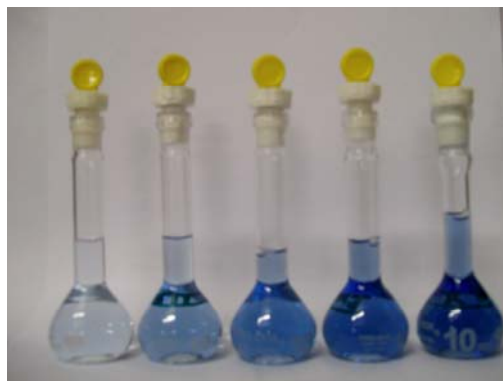
Figura 23: Soluções obtidas para a curva analítica realizada pelo método de UV-vis para o doseamento da NFD.
