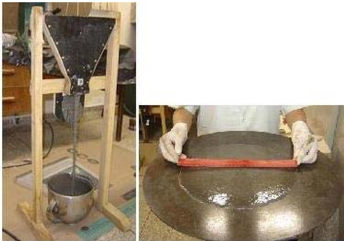
Figura 37 – Ensaio de slump flow e funil em V – argamassas com parâmetros ajustados.
