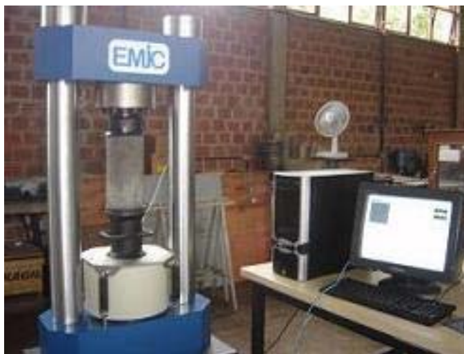
Figura 51 – Ensaio de resistência à compressão do CAA.
