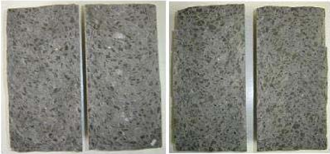
Figura 47 – Corpos-de-prova rompidos à tração, por compressão diametral, com 15% de cinza volante, (a) 100% areia natural; (b) 30% areia de britagem.
