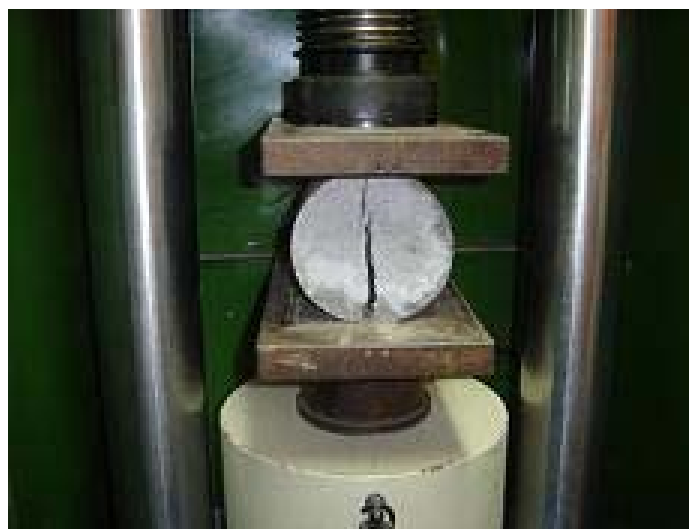
Figura 53 – Ensaio de resistência à tração do CAA, após ruptura.
