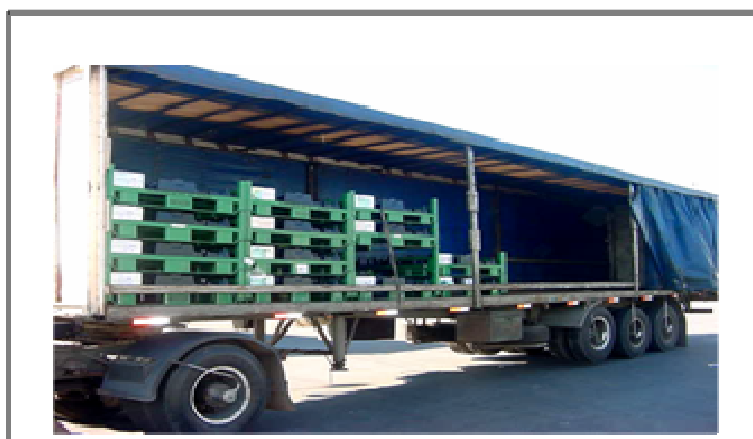
Figura 6: Exemplo de desperdício no aproveitamento volumétrico no transporte de carga.
