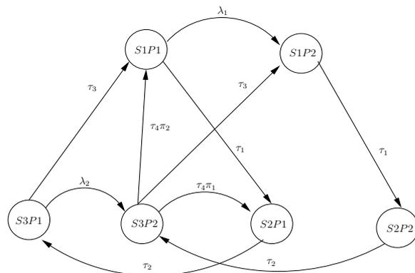
Figura 2: Cadeia de Markov equivalente ao modelo SAN do exemplo 1.
