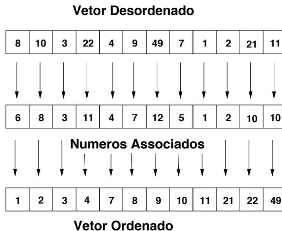
Figura 14: Ilustração do funcionamento da ordenação de vetores sequencial.
