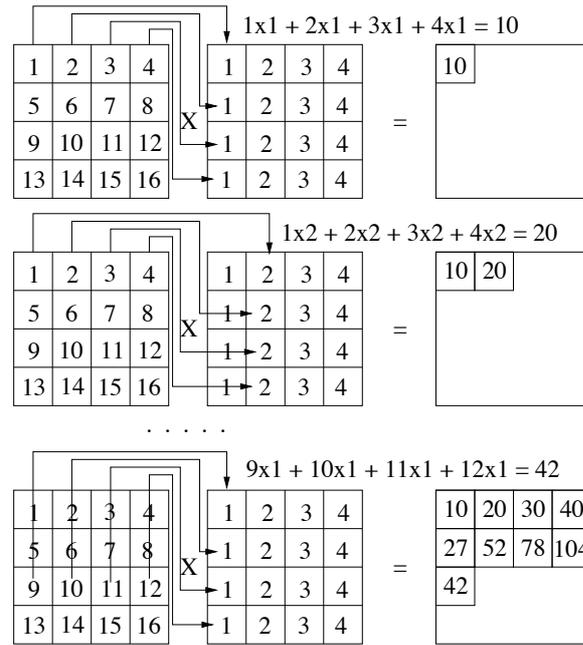
Figura 9: Ilustração do funcionamento da multiplicação de matrizes seqüencial.
