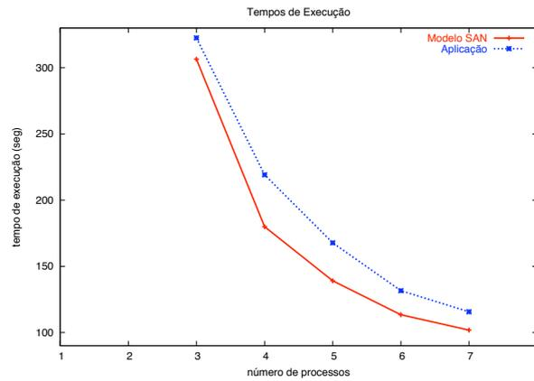
Figura 50: Aplicação FED com 2 elétrons por tarefa
