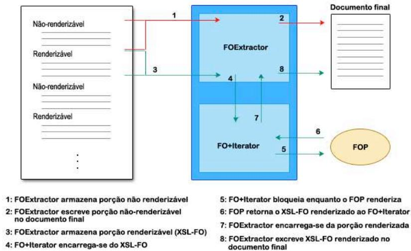
Figura 24: Funcionamento da ferramenta FOP.
