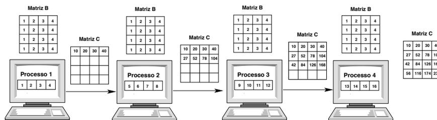
Figura 12: Multiplicação de matrizes com o modelo *pipeline*.
