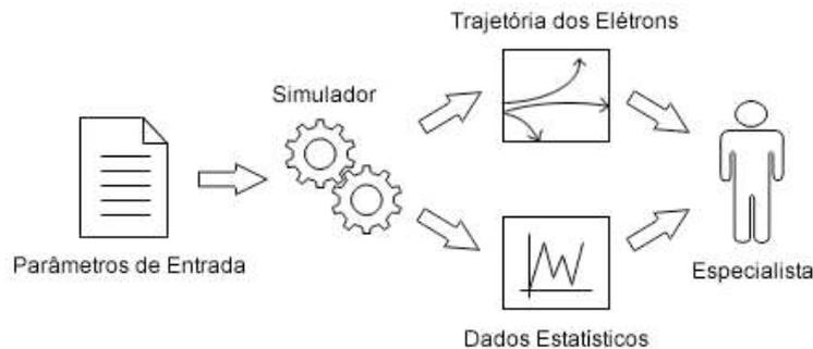
Figura 21: Visão geral do simulador de trajetória de elétrons.
