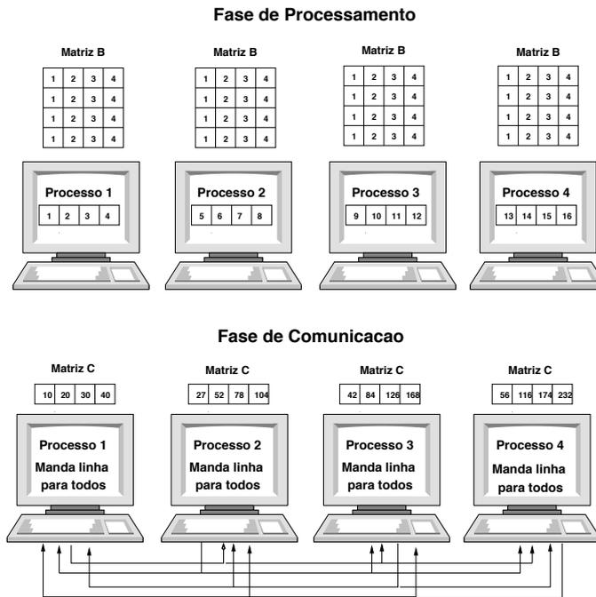
Figura 11: Multiplicação de matrizes com o modelo de fases paralelas.
