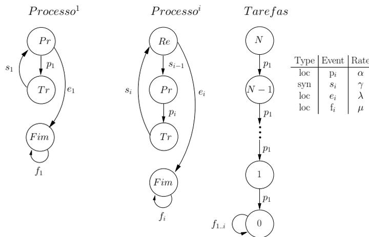
Figura 7: SAN genérico para *pipeline*.
