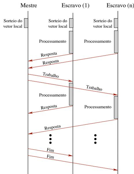
Figura 22: Funcionamento da ferramenta FED em paralelo
