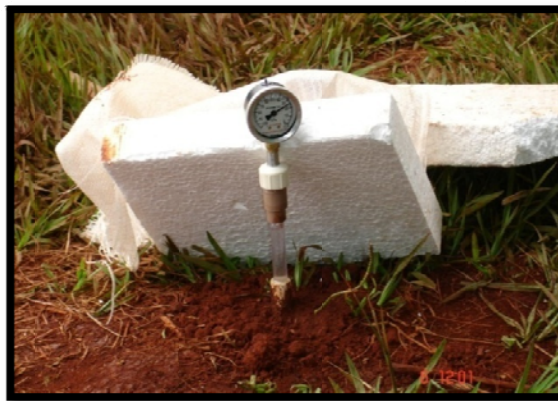
Figura 3.17 - Tensiômetro em operação
