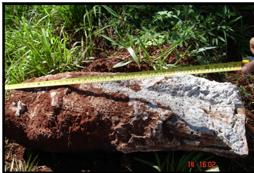
Figura 5.6 - Extremidade superior da estaca S3 extraída
