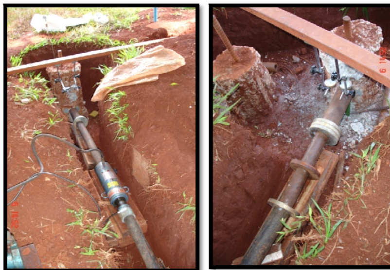
Figura 4.11 - Sistema de aplicação de carga
