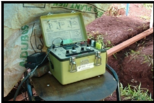
Figura 4.9 – Indutor de deformações
