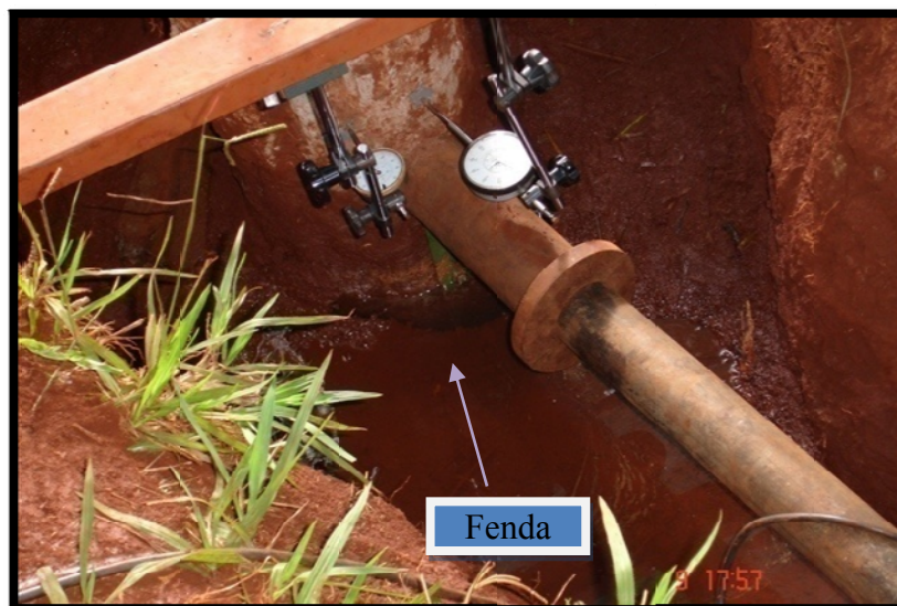
Figura 5.2 - Estaca S2 solicitada com pré-inundação do solo
