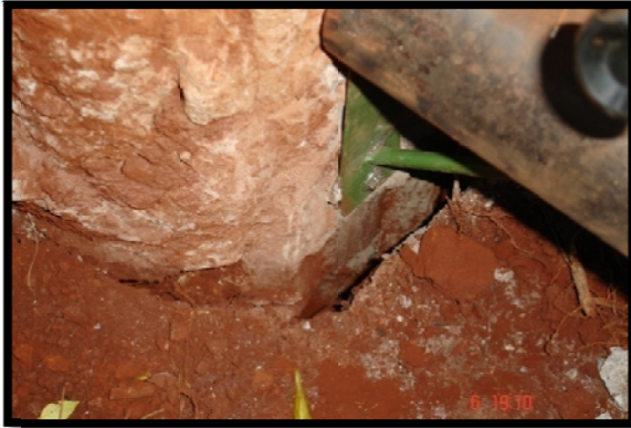
Figura 5.4 - Deslocamento da estaca S3
