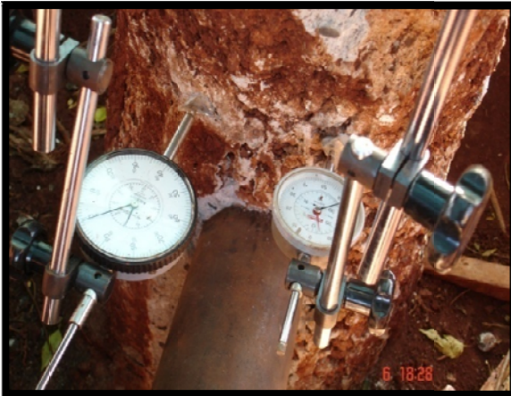
Figura 4.13 - Detalhe dos extensômetros
