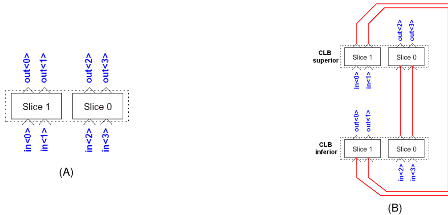
Figura 38 – Macros de Dyer implementadas para dispositivos Virtex: (A) CLB macro simples e (B) CLB macro dupla.
