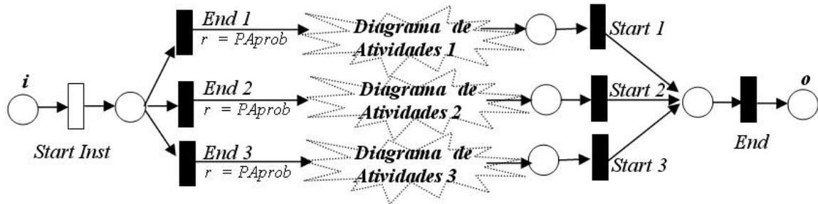
Figura 36: Representação de um caso de uso para teste de desempenho utilizando *WfGSPN*.
