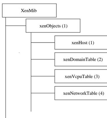
Figura 19 – Sub-árvore Xen Objects da Xen MIB.
