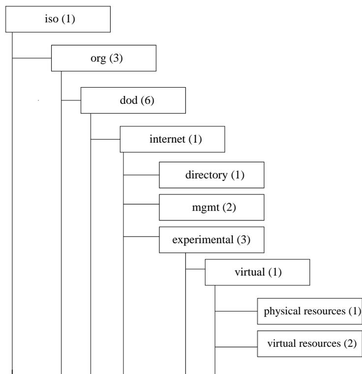
Figura 30 – Definição do Objeto vMIB (virtual).
