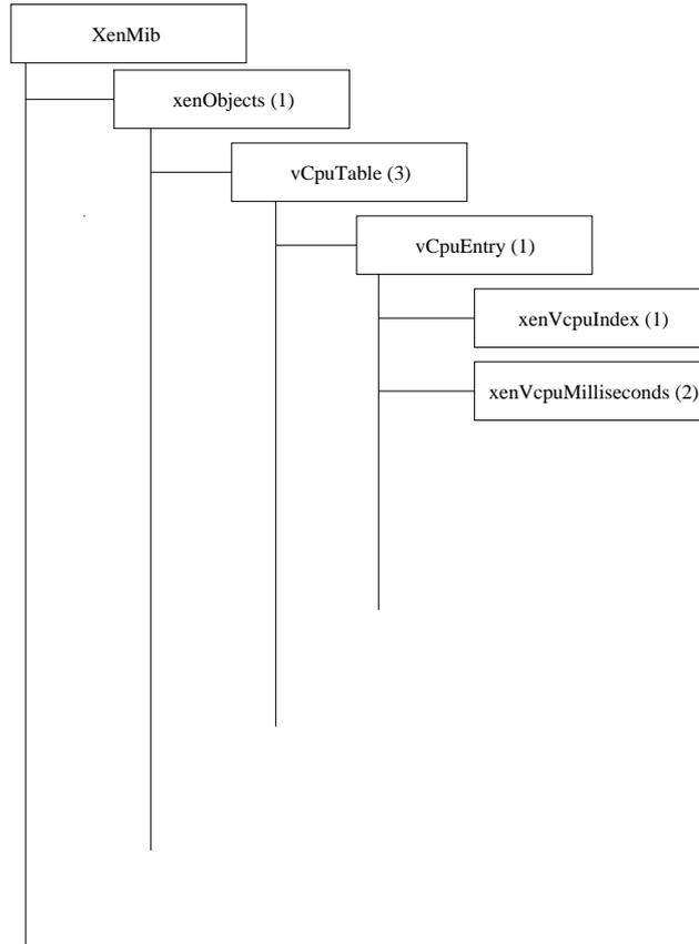
Figura 22 – Sub-árvore VCPU da Xen Objects.
