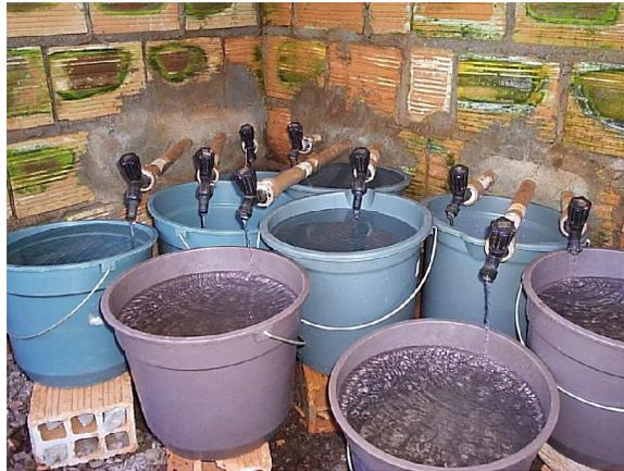
**Figura 7** Pontos de coleta do percolado de cada lisímetro.
