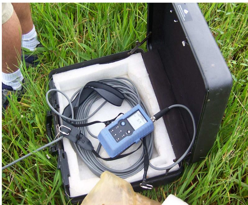
Figura 3. Equipamento multiparâmetros (Horiba U-22)
