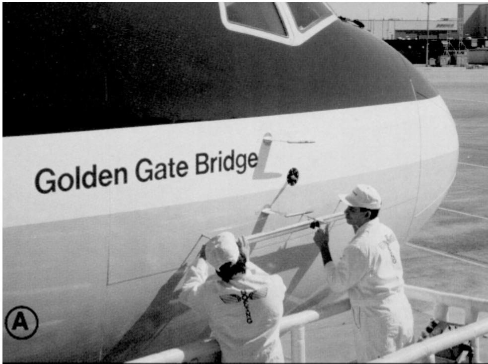
Figura 2.10: Medição das ondulações na superfície da fuselagem (Boeing, 1996)
