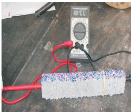
FIGURA 3.11 Circuito fechado com Multímetro Digital Minita et 2020.
