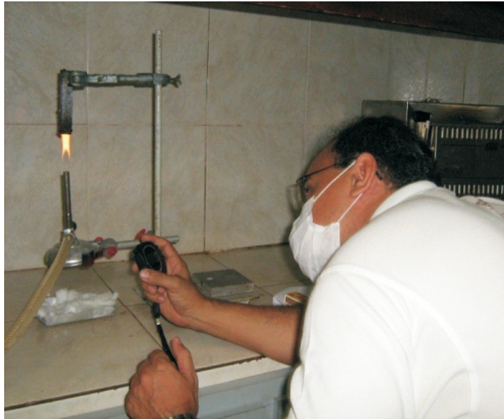
FIGURA 4.16 Ensaio de flamabilidade
