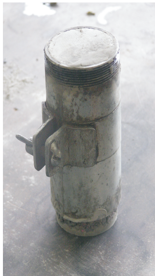
FIGURA 3.3 Corpos de prova cilíndricos, com 5 cm de diâmetro e 10 cm de altura
