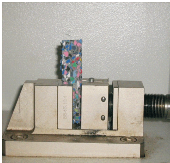
FIGURA 3.10 Detalhe do encaixe do corpo de prova
