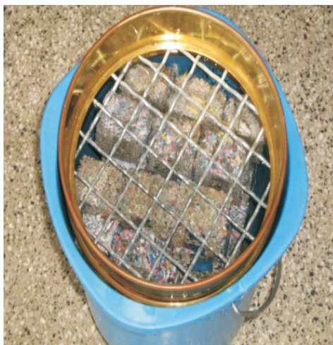
FIGURA 3.8 Detalhes do ensaio de absorção: material imerso
