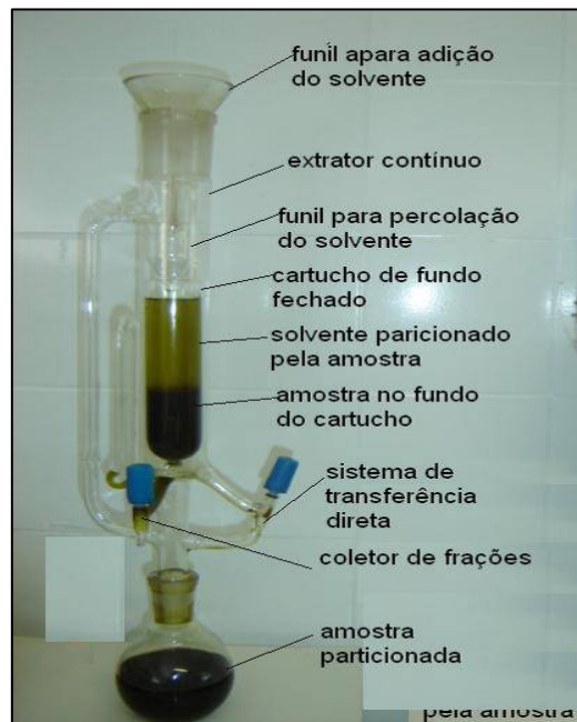
FIGURA 11 – EXTRATOR SOXHLET MODIFICADO PARA EXTRAÇÃO COM GRADIENTE DE POLARIDADE DE SOLVENTE COM AMOSTRA
