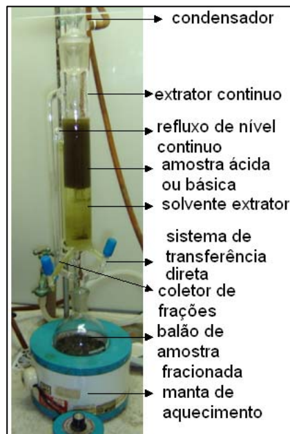
FIGURA 12 – EXTRATOR SOXHLET MODIFICADO PARA EXTRAÇÃO EM MEIO ÁCIDO E MEIO BÁSICO
