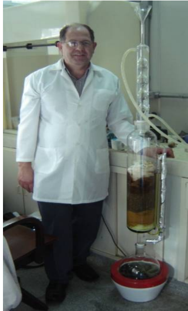
FIGURA 7 – APARELHO SOXHLET FARMACOTÉCNICO MODIFICADO PARA 2000g DE DROGA VEGETAL
