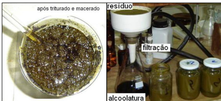
FIGURA 4 – PREPARO DA ALCOOLATURA, VISÃO APÓS MACERADO E SISTEMA DE FILTRAÇÃO A VÁCUO.
