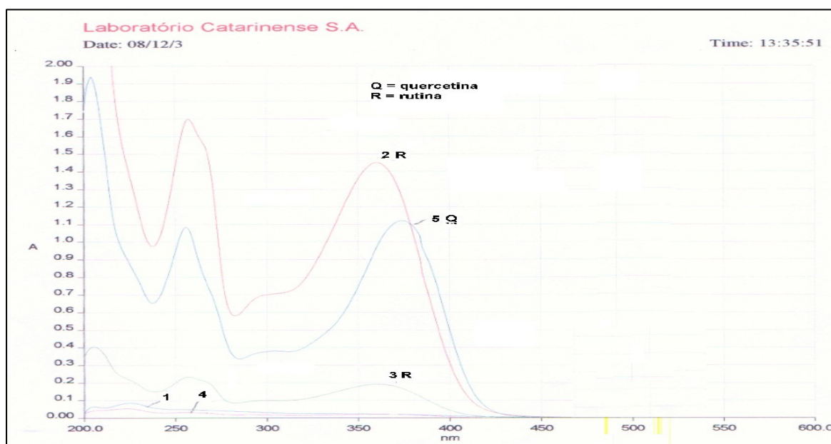
FIGURA 128 – ANÁLISE, POR ESPECTROFOTOMETRIA UV, DAS REFERÊNCIAS RUTINA E QUERCETINA OBTIDAS NO PARTIÇÃOAMENTO POR SEPHADEX LH 20
