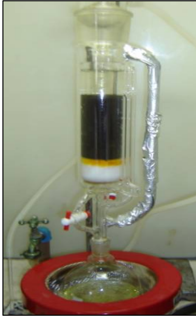
FIGURA 9 – APARELHO SOXHLET FITOQUÍMICO MODIFICADO
