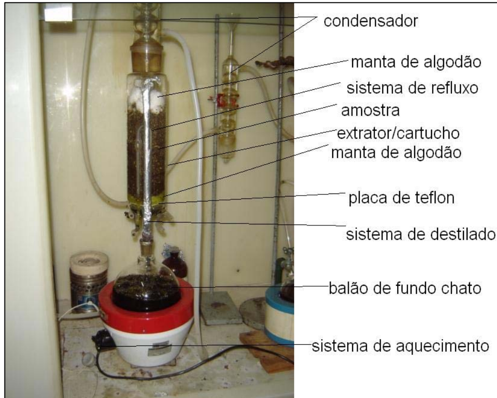
FIGURA 6 – APARELHO SOXHLET FARMACOTÉCNICO MODIFICADO PARA 500g DE DROGA VEGETAL
