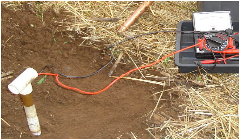
Figura 9. Esquema de medição da resistência elétrica do solo com ohmímetro
