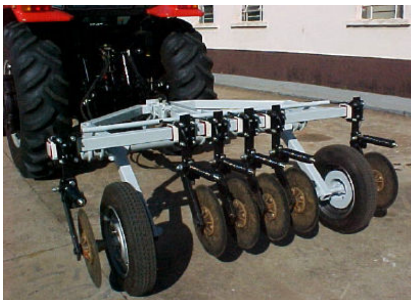
Figura 6. Implemento de condutividade elétrica Veris 3100
