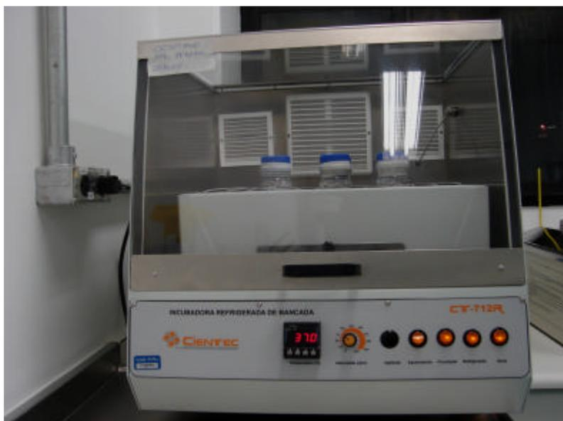
Figura 6: Frascos sob agitação e temperatura controladas para obtenção do extrato da liga Ti-6Al-4V
