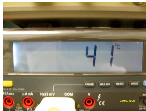
Figura 79 – Temperatura medida diretamente da face metálica do transformador protótipo
