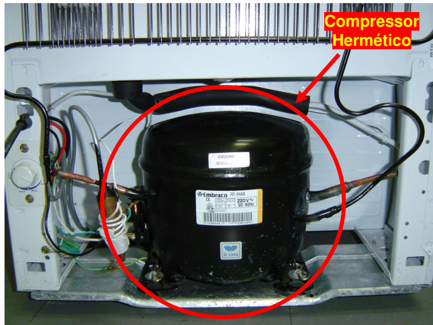
Figura 3.2 – Detalhe do compressor hermético do freezer sob estudo.
