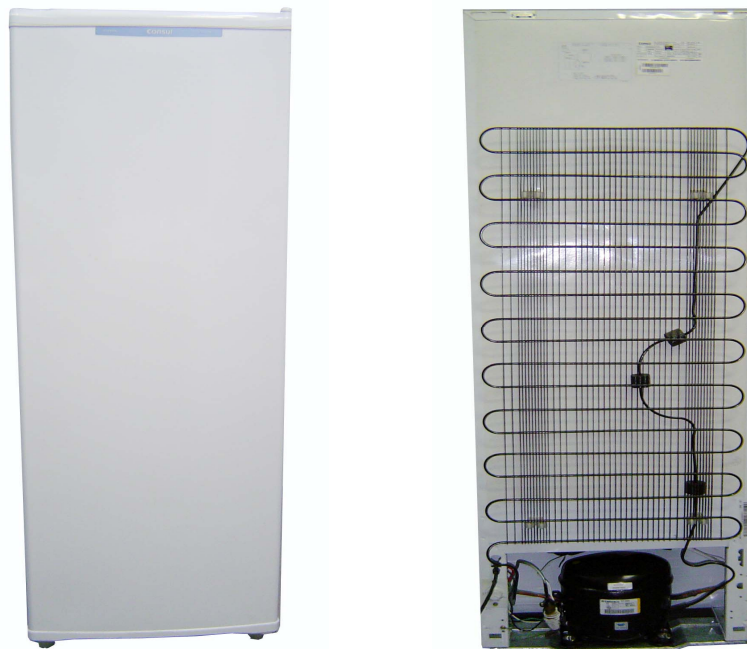
Figura 3.1 – Freezer doméstico sob ensaio.
