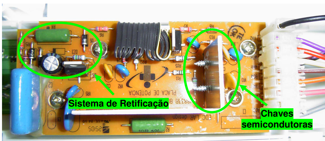
Figura 5.3 – Detalhe do circuito eletrônico da máquina de lavar roupas sob estudo.
