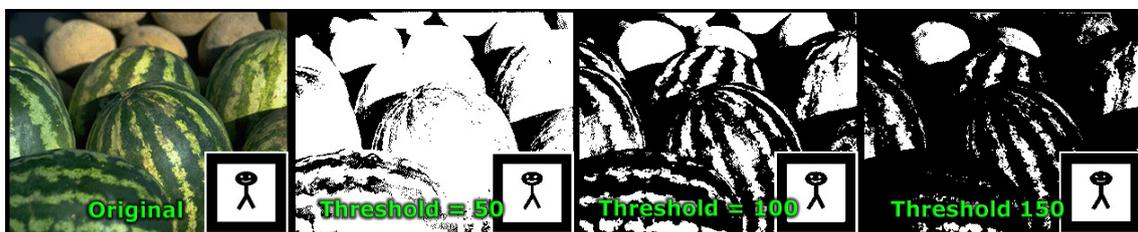
**Figura 2.8 – Imagem Transformada com Diferentes valores de limiar/threshold.**
