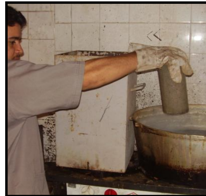
Figura 4.26 – CPs na fase de fervura.
