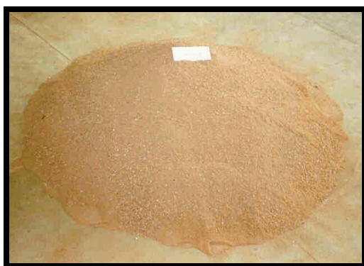
Figura 2.16 - Aspecto do agregado miúdo reciclado (ZORDAN, 1997).
