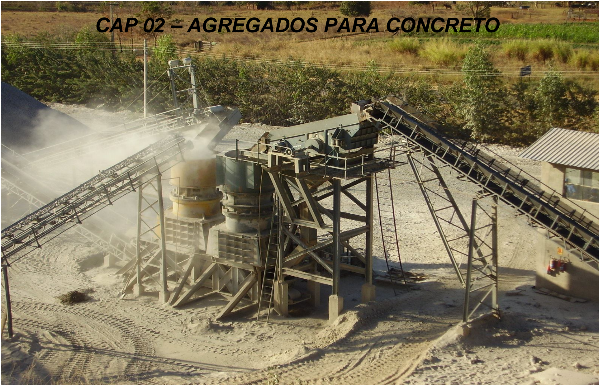
Figura 2.13 – Britadores da planta de britagem da Britagran
