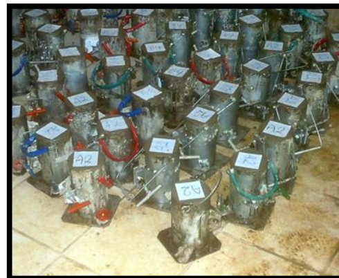
Figura 4.16 – Moldagem dos corpos-de-prova cilíndricos.
