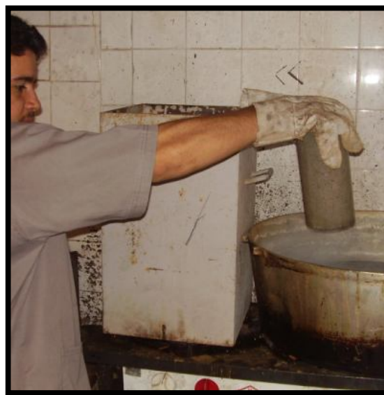
Figura 4.26 – CPs na fase de fervura.
