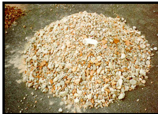
Figura 2.17 – Aspecto do agregado graúdo reciclado (ZORDAN, 1997).
