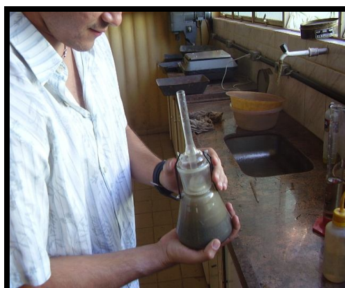
Figura 4.11 – Recipiente com areia e água.
