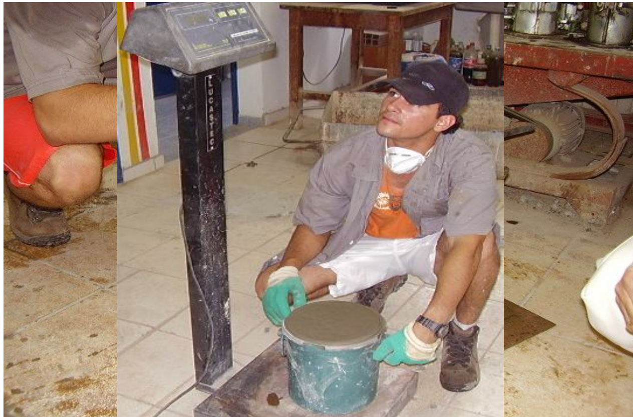
Figura 4.19 – Ensaio no concreto fresco: massa específica. NBR 9.853 (ABNT, 1987). cone1 NBR 67 (ABNT, 1990) 1982a).
