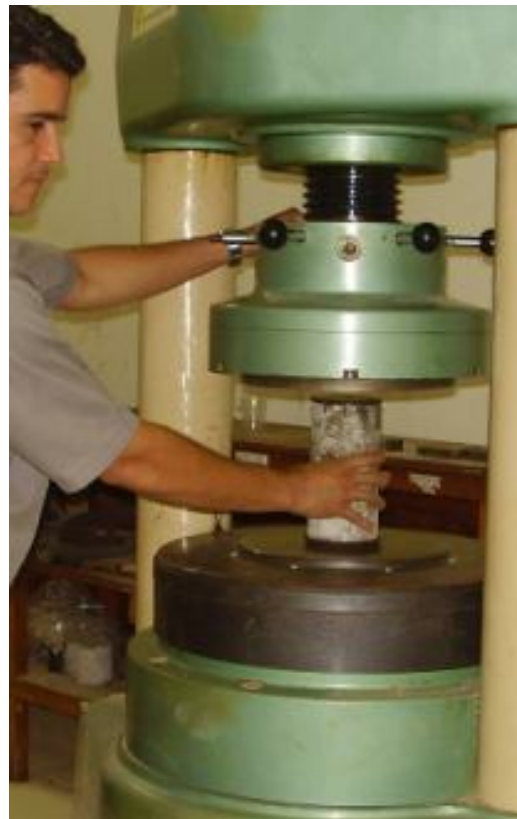
Figura 4.20 – Ensaio de resistência à compressão sendo preparado . NBR 5.739 (ABNT, 1994a)
