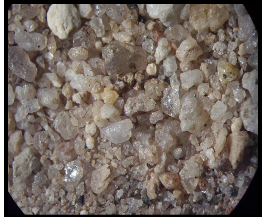
Figura 5.6 – Imagem ampliada dos grãos de areia natural.
