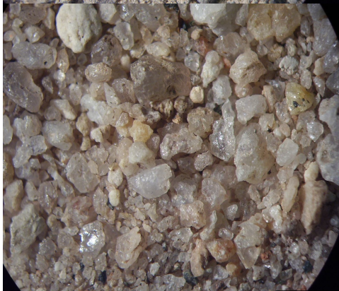
Figura 5.6 – Imagem ampliada dos grãos de areia natural.
