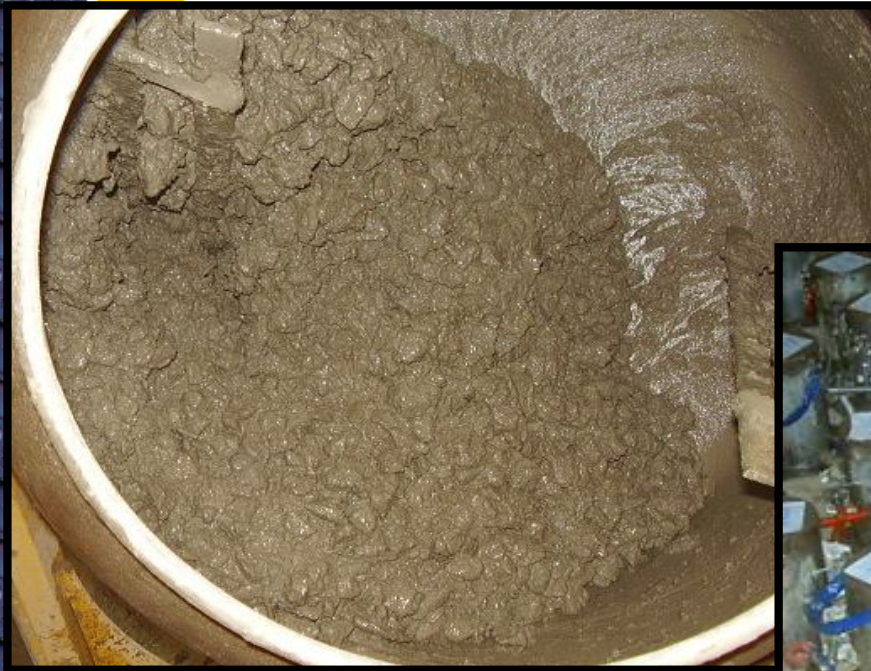
Figura 4.15 – Preparação de concreto na betoneira.
