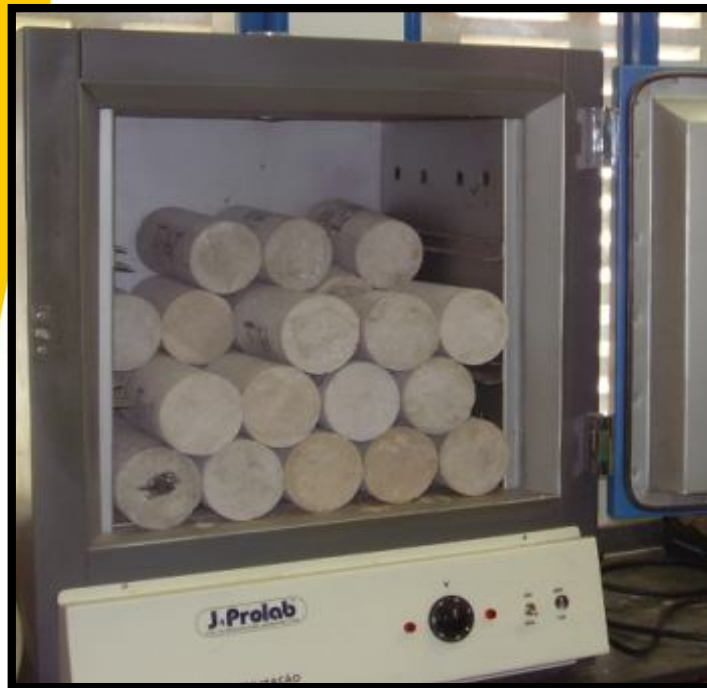
Figura 4.25 – Ensaio de absorção sendo realizado – CPs na estufa . NBR 9.778 (ABNT, 1987e)
