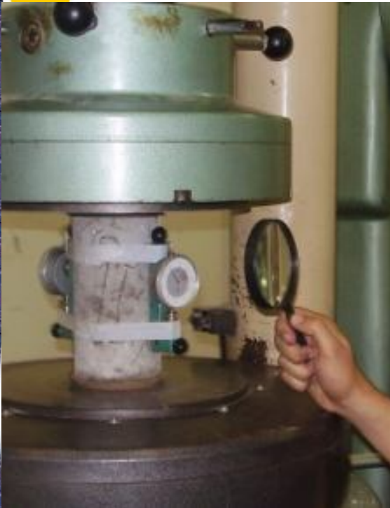
Figura 4.23 – Ensaio de módulo de deformação, utilizando medidor mecânico de deformação. NBR 8.522 (ABNT, 1984).
