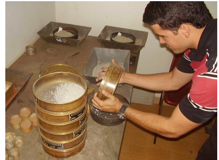
Figura 4.7 – Areia sendo peneirada.
