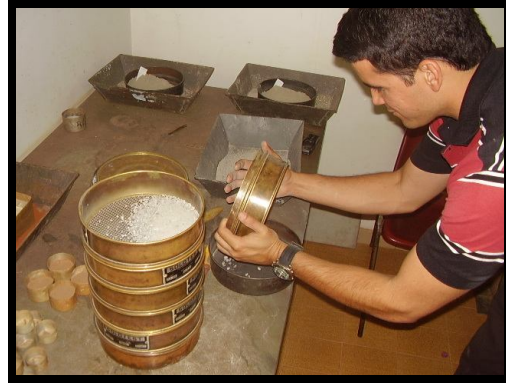
Figura 4.7 – Areia sendo peneirada.
