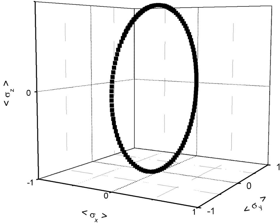
Figura 3.3: Trajetória polar sobre a esfera de Bloch realizada pelo sistema para o conjunto de parâmetros:  $\Omega_1 = 2,5 \times 10^2 \lambda_a$ ,  $\Omega_2 = 50 \lambda_a$ ,  $\Gamma = 20 \lambda_a$  e  $\gamma = 10^{-2} \lambda_a$ .
