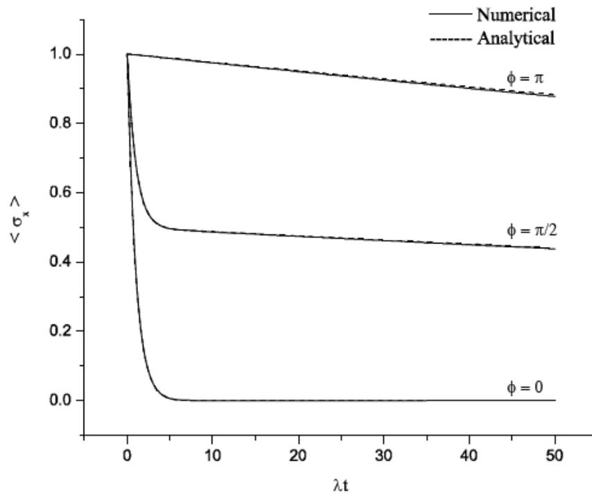
Figura 4.4: Evolução de  $\langle \sigma_x(t) \rangle$  segundo o conjunto de parâmetros ( $r = 1.5$ ,  $\Gamma = 40\lambda$ ,  $\gamma = 0$ ) para os ângulos de compressão ( $\phi = 0, \pi/2$  e  $\pi$ ).
