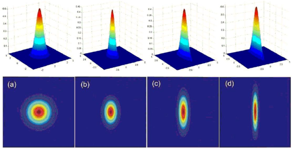
Figura 4.3: função the Wigner associada ao estado do campo da cavidade, inicialmente no vácuo e após a passagem de 50, 100 e 200 átomos.
