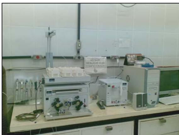
Figura 16. Espectrômetro de absorção atômica com vapor frio, modelo FIMS 400 (Perkin Elmer), associado a um sistema de injeção em fluxo, modelo FIAS 400 (Perkin Elmer) e equipado com um sistema automático de amostragem líquida, modelo AS 90 (Perkin Elmer).
