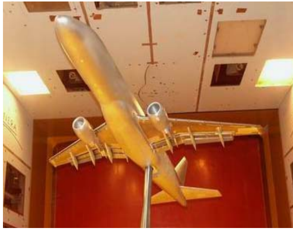
Figura 1.2: Ensaio em túnel de vento e simulação computacional do escoamento em aeronaves da Embraer.
