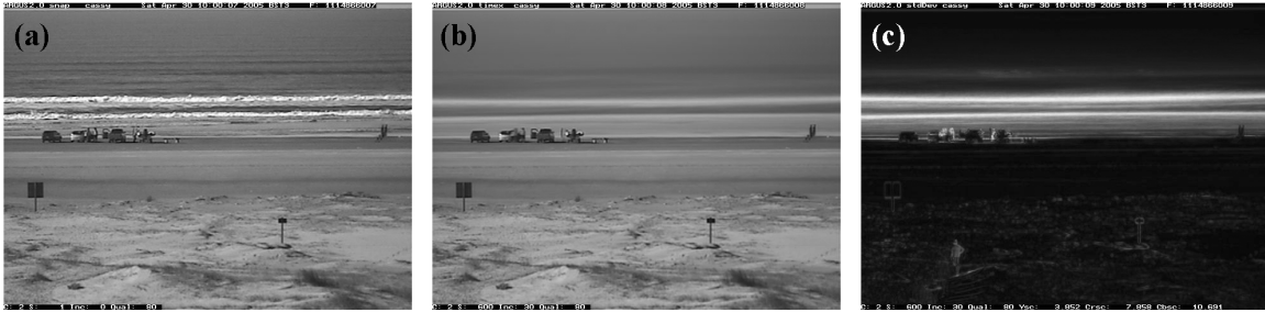
Fig. 3: Imagens instantâneas (a), Timex (b) e Variance (c) obtidas com a câmera 2 do Sistema Argus da Praia do Cassino em 30 de abril de 2005.
