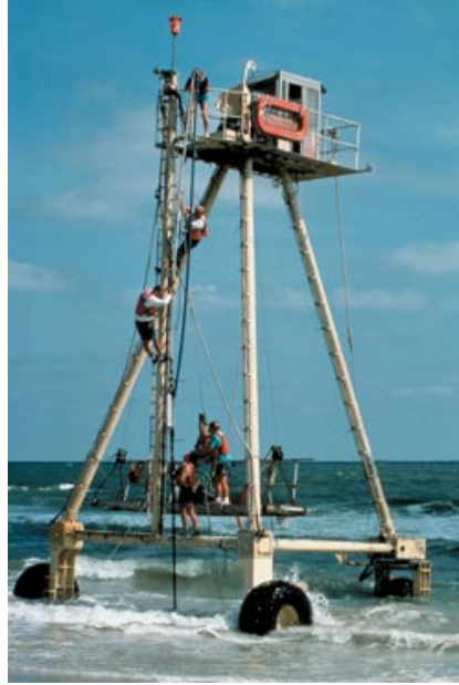
Fig. 12: Veículo motorizado (CRAB) utilizado pelo Field Research Facility (FRF), NC, EUA, para o levantamento de perfis topográficos na praia de Duck. Fonte: http://www.whoi.edu/oceanus/index.do
